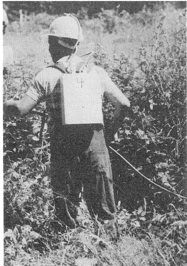
Abb. 2: Meßsystem zur Erfassung des Mikroklimas im Schutzhelminnenraum
