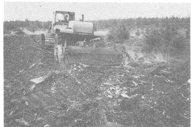
Abb. 2: Beseitigung und Zerkleinerung von Schlagabraum- und Stockwällen aus dem Windwurf 1972
