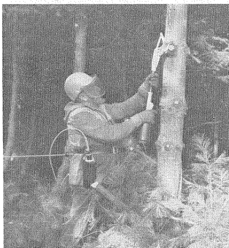
Abb. 1: Druckluftschlauch vom Kompressor mit Abzweigung zur Handschere im Gürtelhalter und Hakenschere im Einsatz bis zur Höhe von 2,40 m.
