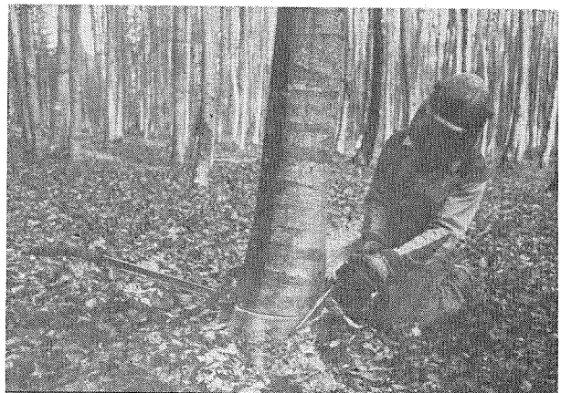
Abb. 2: Schneiden des Fallkerbes im Knien.
