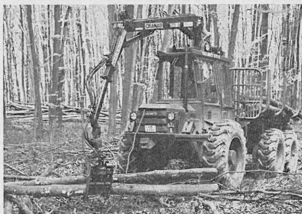
Abb. 5: Forstspezialrückezug Valmet 872 K beim Rücken von Laub- und Industrieholz in Abschnitten im Forstamt Weilburg Foto: E. Weber
