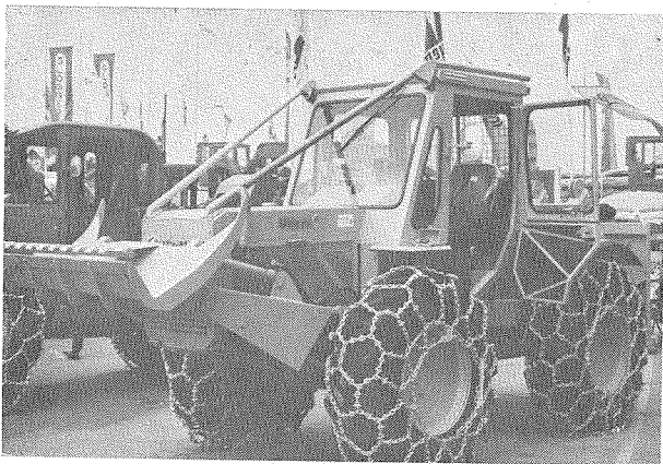
Abb. 2: Forstspezialschlepper HSM-704, wie WELTE-ES 70 B-Jubi-trac, für mitteleuropäische Bedingungen konzipiert und FPA-anerkannt.
