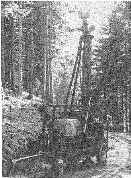
Abb. 1: Kippmastseilkran Mini-Urus (AUSTROFOMA)
