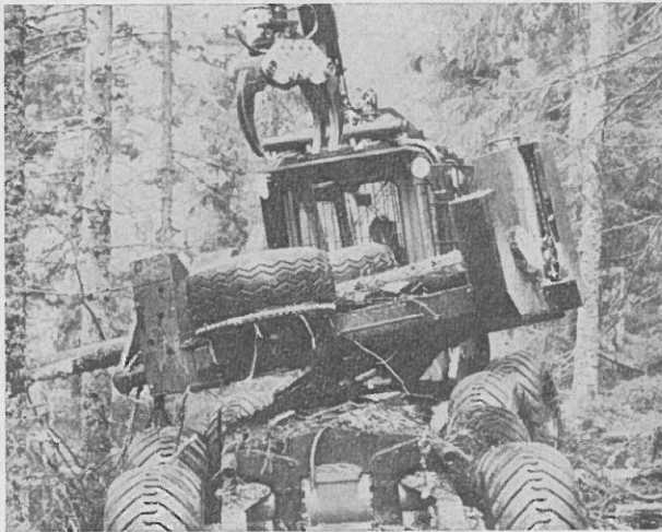
Abb. 2: Processoreinheit mit neuartigem, holzschonendem, griffstem Einzugsystem, hydraulisch angepreßter Meßrolle, Mikroprocessorsteuerung. Der dachmontierte Beschickungskran schafft gute Sicht auf dem Processor
