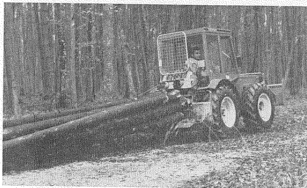
Abb. 7: Holder-Cultitrac A 60 mit Schlang & Reichart Anbauwinde (Werkfoto)
