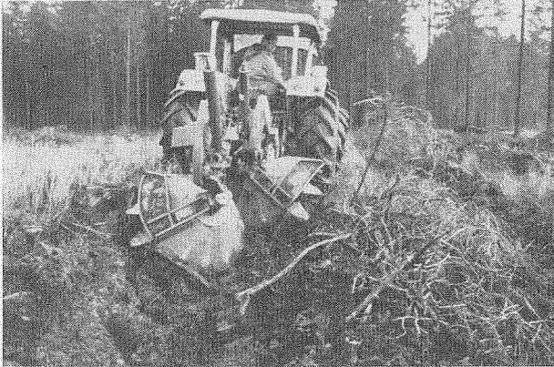
Abb. 2: V-förmige Anordnung der Scheiben erhöht die Räumintensität auch in teilgeräumten, grasbewachsenen Flächen
