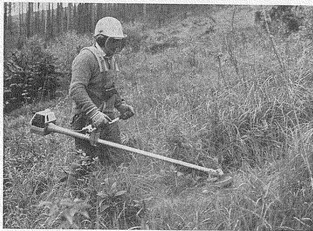
Abb. 2: Kulturpflege mit dem vibrationsgedämpften Freischneidegerät im Zuge eines Verfahrensvergleiches. (fot. K. Heil)
