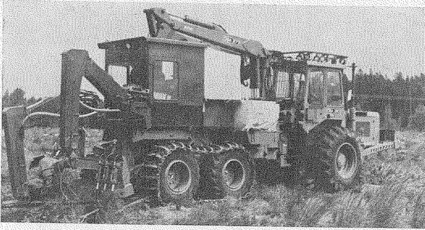
Abb. 3: OSA 650 - Pflanzmaschine mit Bodenbearbeitungs- und Pflanzeinheit
