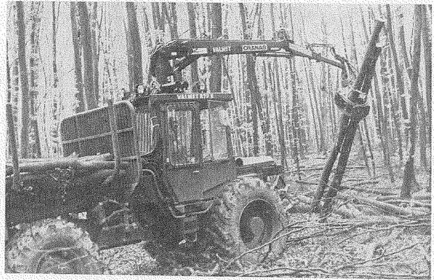
Abb. 4: Leistungsermittlung beim Transport des 4-6 m langen Buchen-Industrieholzes mit dem Valmet-Forst-Spezial-Rückezug. (fot. E. Weber)
