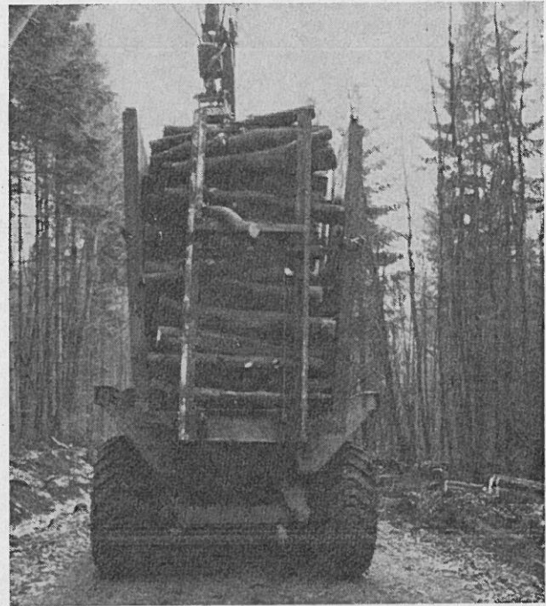
Abb. 3: Rückeaufbau des LHR 72-83 zur Bringung von 1 m langen Sortimenten
