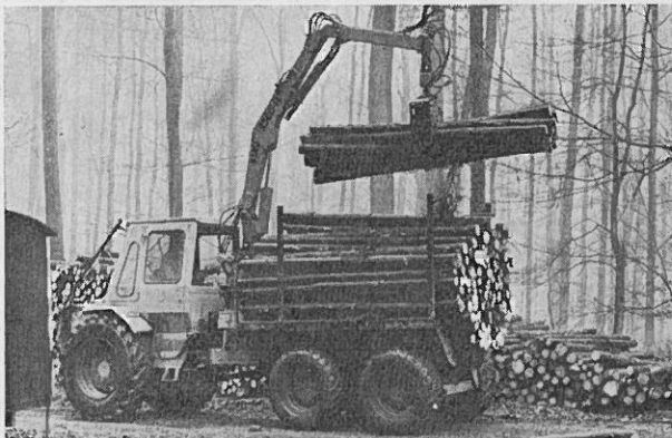
AAb 1: Der LHR 72-83 mit Ladekran FMV 2500-H beim Abladen von 3 m langem Industrieholz
