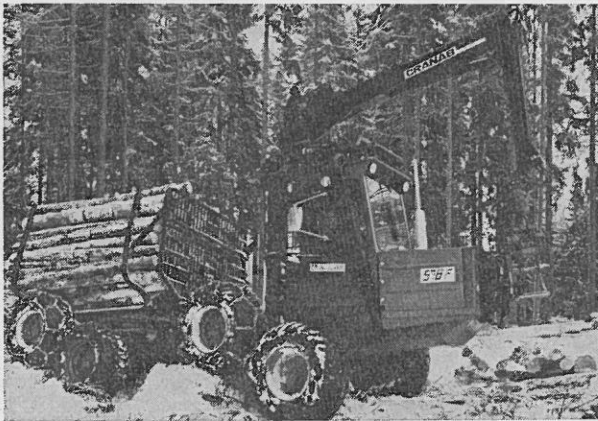
Abb. 1: Forwarder mit Doppel-Tandemachse, dachmontiertem Kran, nach innen gewölbten Laderungen und günstigen Außenabmessungen
