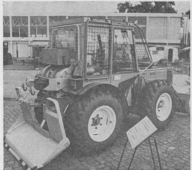
Abb. 3: Holder A 60 F mit Schlang & Reichart 2 × 25 kN Doppeltrommelwinde
