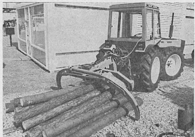
Abb. 6: Farni JKP-Anbauzange für die Bringung von Schicht- u. Langholz
