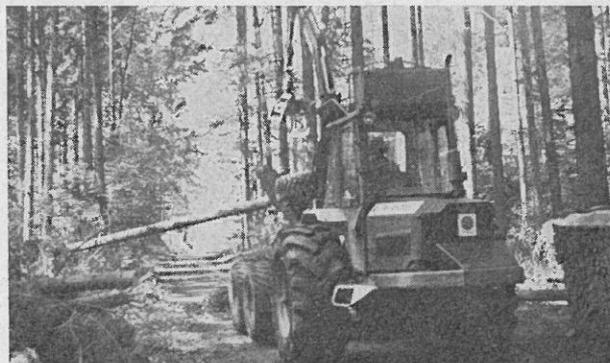
Abb. 2: Processor bei der Arbeit
