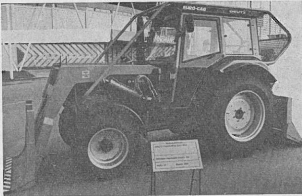
Abb. 1: Deutz 6207 A (44 Kw) mit Ritter-Forstausrüstung (Poltergabel mit für die Schlagräumung geeigneten, aufsteckbaren Zinken, 2 × 45 kN Doppeltrommelwinde und Schutzeinrichtungen)
