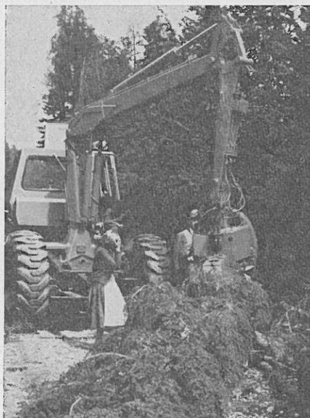
Abb. 1: OBF-Schwachholzprocessor, am Kran montiert
