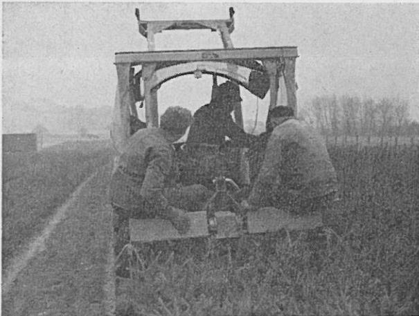
Abb. 3: Der HOH-Anbau-Aushebeplag mit Rüttelwerk für ganze Beete im Einsatz. Links im Bild ein bereits abgeerntetes Beet.
