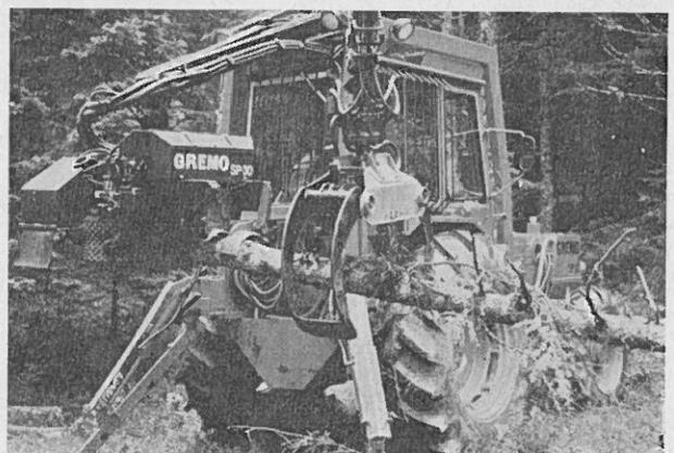
Abb. 3: Teilmechanisierte Holzernte (Entasten und Ablängen an der Waldstraße)
