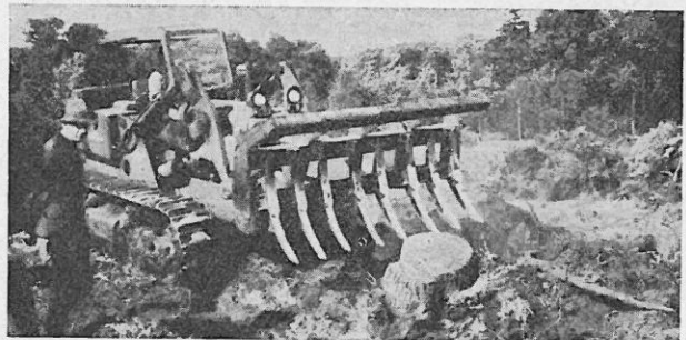
Abb. 1: Raupe mit Roderechen, die auch zum Reisigzusammenschieben eingesetzt werden kann.
