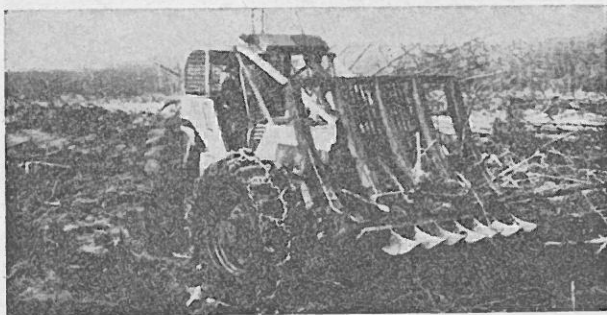
Abb. 3: Forstspeziialschlepper mit Reisigrechen (eigene Konstruktion).
