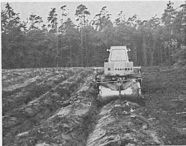
Abb. 4: Herstellung von Dämmen mit dem Rome-Aufdämmscheibenpflug TRBR 6/30
