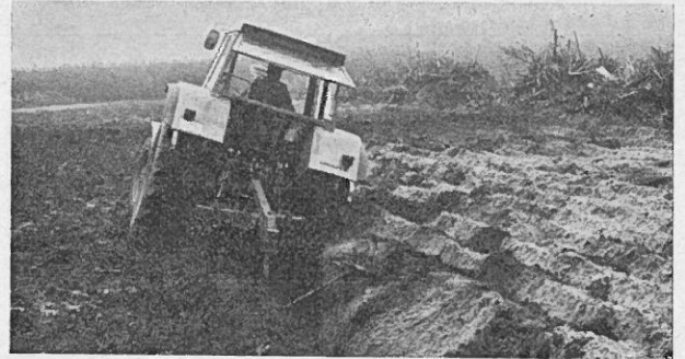
Abb. 3: Vollumbruch mit landwirtschaftlichem Schlepper (100 kW) auf 40 – 50 cm Tiefe
