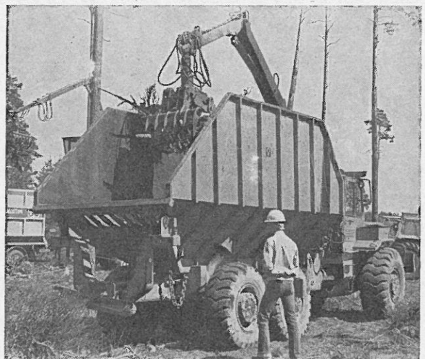
Abb. 12: umgebauter Forwarder für Stubben und Schlagabraumtransport der Firma Cranab
