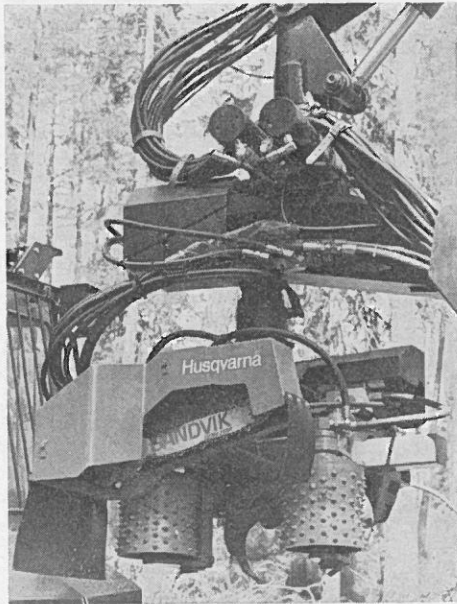
Abb. 3: Entastungs- und Einschnaidekopf des Husqvarna SP 26
