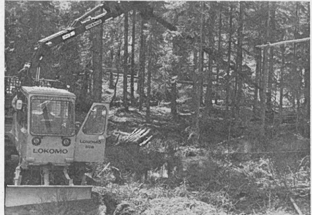
Abb. 5: weitreichender Cranab-Kran 7010 auf Lokomo 928
