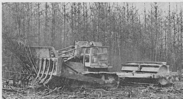
Abb. 3: Die vom Maschinenhof kürzlich beschaffte FLECO-Hackwalze, Arbeitsbreite 3,66 m, Gewicht mit Wasserfüllung 14,1 t, gezogen von einer 270 PS Caterpillar-Raupe, bewährte sich beim Einarbeiten nicht verwertbarer schwächerer Waldbrandbestände sowie bei der Zerkleinerung von Schlagabraum. (Fot. Heil)
