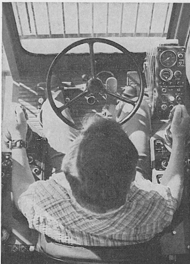
Abb. 1: Blick auf den nach ergonomischen Gesichtspunkten gestalteten Arbeitsplatz eines Forstmaschinenführers. Alle Bedienelemente und Kontrollinstrumente sind übersichtlich und leicht zugänglich angeordnet.
