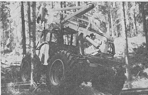
Abb. 1: Anbauprocessor auf Kockum Rückeschlepper
