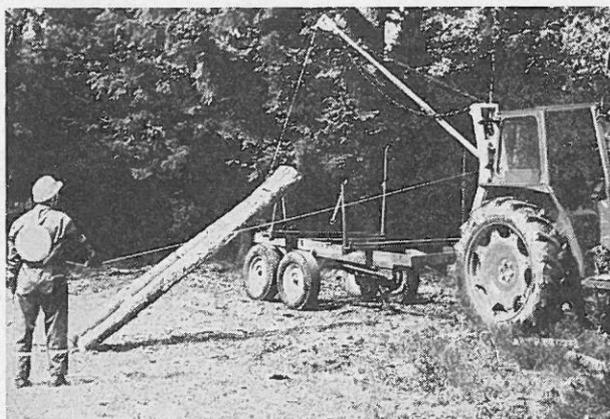
Abb. 1: Windenfernsteuerung mit Hilfe eines Seiles
