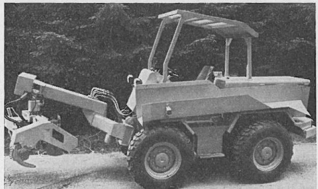
Abb. 11: Sifer-Anbauprocessor mit Trägerfahrzeug
