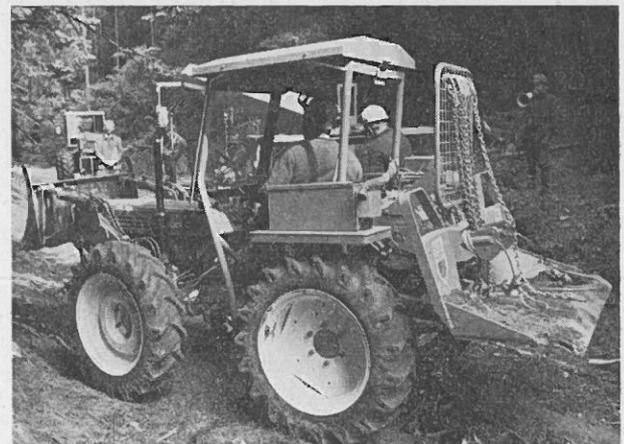
Abb. 3: Holder A 55 F mit S & R - Doppeltrommelwinde
