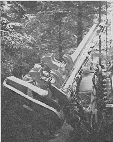
Abb. 7: Vollernter Werner Hürtgenwald, hier das Fällaggregat mit Kreissäge
