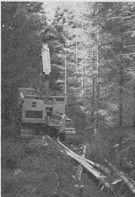
Abb. 8: Vollernter Intertrac, in der von ihm geöffneten Gasse
