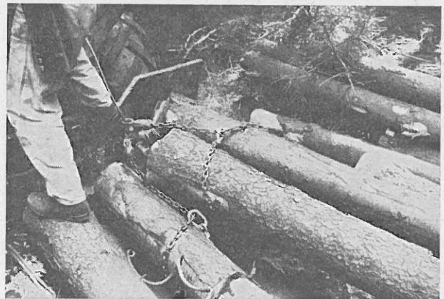
Abb. 6: System der RUD-Chokerkette mit Verkürzungsklauen
