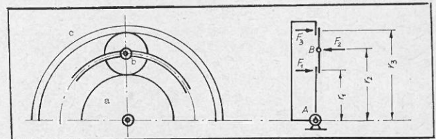
Abb. 6: Kraft- bzw. Momentenaufteilung beim Umlaufgetriebe Kräftegleichgewicht am Planetenrad b F_2 = F_1 + F_3 Momentengleichgewicht am Planetenrad b (Summe der Momente um B gleich Null) F_1 = F_3 Momentengleichgewicht um die Achse A F_2 \cdot r_2 = F_1 \cdot r_1 + F_3 \cdot r_3 Daraus folgt die Hauptgleichung für das Planetengetriebe M_1 + M_2 + M_3 = 0
