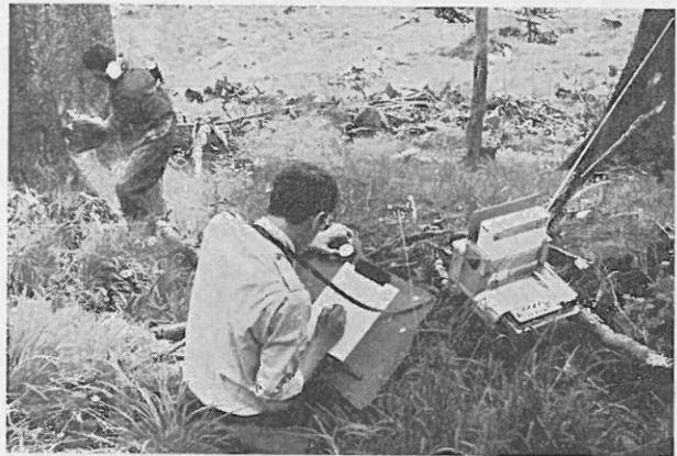
Abb. 4: Ergonomisch-arbeitstechnische Untersuchungen bei der Nadelholzschlägerung in Einmannarbeit mit Motorsäge. Die Arbeitsbelastung — hier beim Fällschnitt — wird mittels telemetrischer Pulsfrequenzmessung festgestellt und vom Schreiber registriert.
