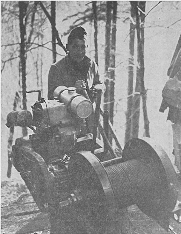
Abb. 2. In Traglasten zerlegbare „Mariabrunner Holzabseil- und -rückmaschine“ mit 6 PS-Motor, für Stockerankerung, in Arbeitsstellung.
