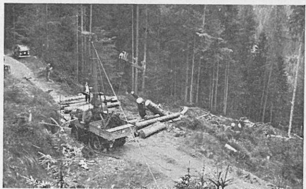
Abb. 5: Zeitstudien bei der Holzrückung mit mobilem Kurzstreckenseilkrane „URUS“ in einem Kärntner Forstbetrieb.
