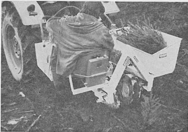
Abb. 2: Die Andrückräder der Maschine mit Pflanzbehälter. (Foto Haselgruber)
