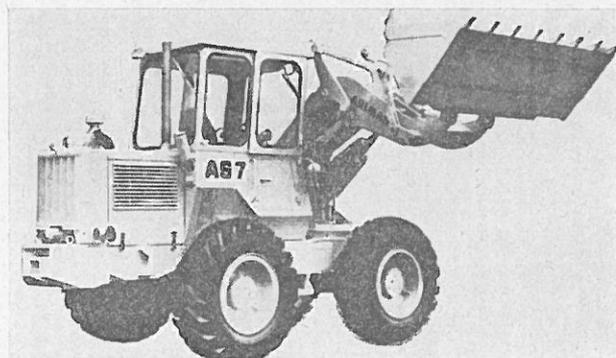
Abb. 2: Ahlmann Schwenklader AS 7 (Werkfoto)
