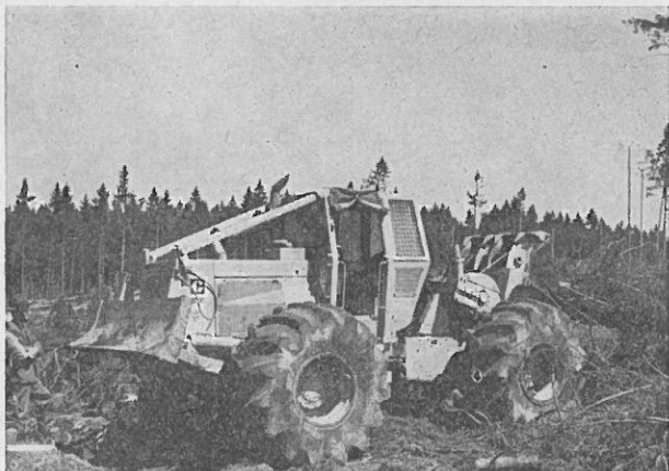
Abb. 1: Rücken von gezopften, jedoch nicht entasteten Fichten zum Rohpolter mittels schwerem Bringungsschlepper Caterpillar 518 — 125 SAE-PS
