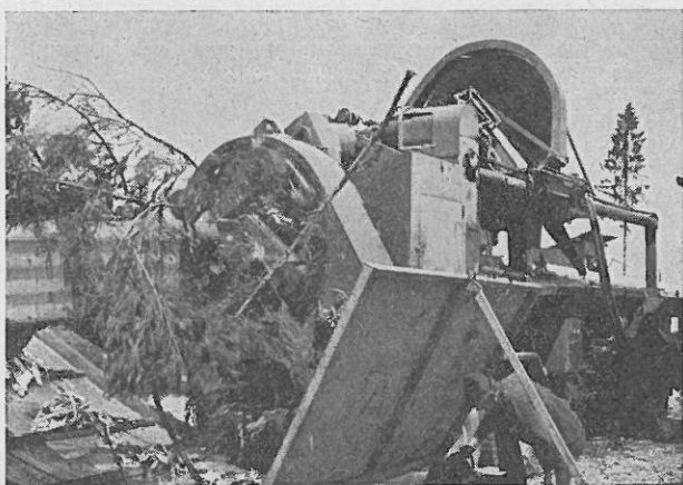
Abb. 6: Entastungsaggregat bei der Arbeit
