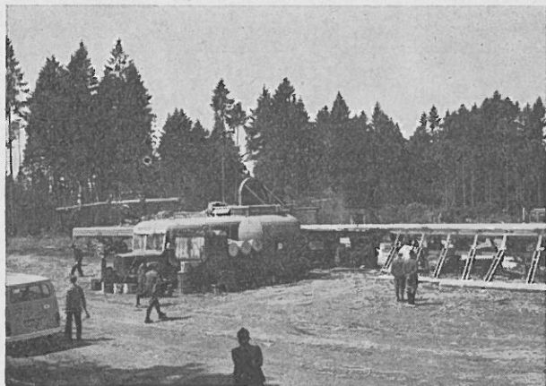
Abb. 4: Gesamtübersicht zum Österreichischen Holzerntezug — Beschickungs- (links) und Sortiments-Transporteur (rechts), Entaster, Entrinder und Kappsäge (Mitte)
