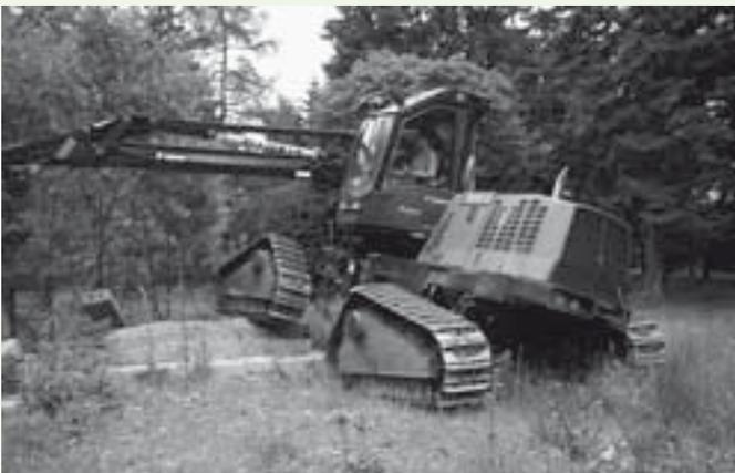
Abb. 2: Kranvollerter mit Raupenfahrwerk in schwerem Gelände; Längsverschränkung durch zentrales Verschränkungsgelenk, weitere Verschränkung durch Pendelbewegung der Raupenlaufwerke
