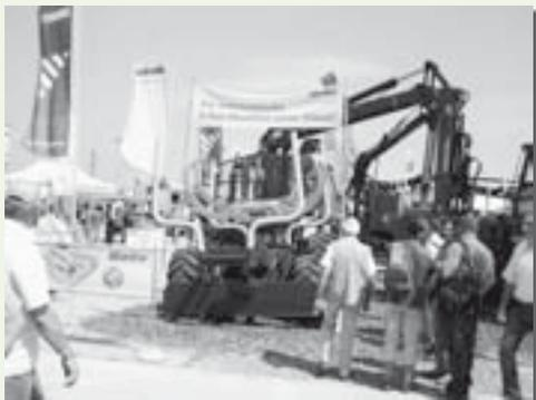
Tragschlepper mit Seilwinde und Klemmbank
