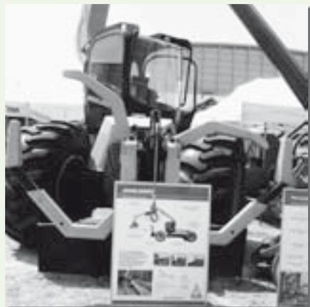
Schlepper mit Seilwinde, Kran und Doppelklemmbank
