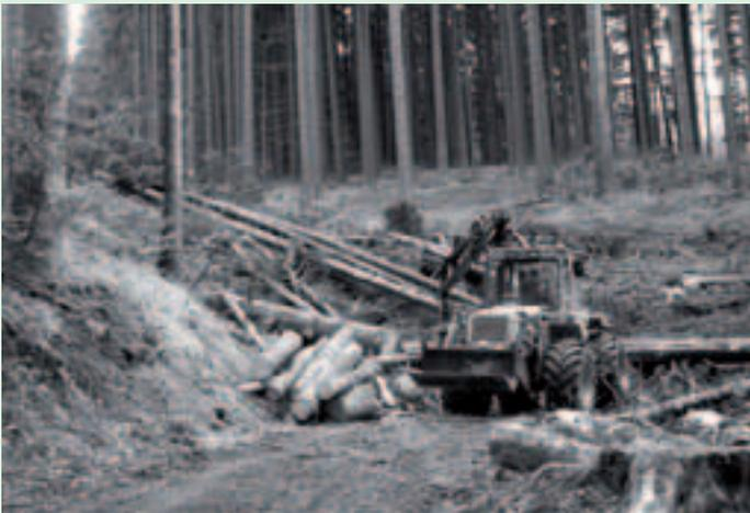
Abb. 1: Rückefahrzeug HSM 805 C beim Bergabziehen von ganzen Bäumen mit dem Kunststoffseil.
