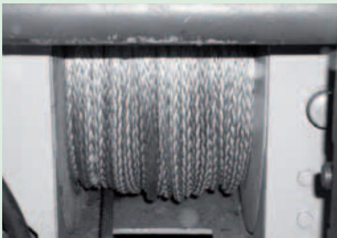
Abb. 2: Hervorragende Seilwicklung auf der Seiltrommel.
