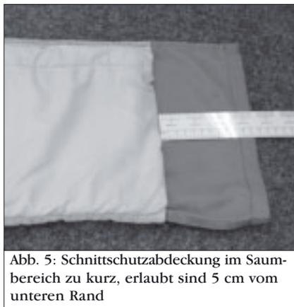
Abb. 5: Schnittschutzabdeckung im Saumbereich zu kurz, erlaubt sind 5 cm vom unteren Rand
