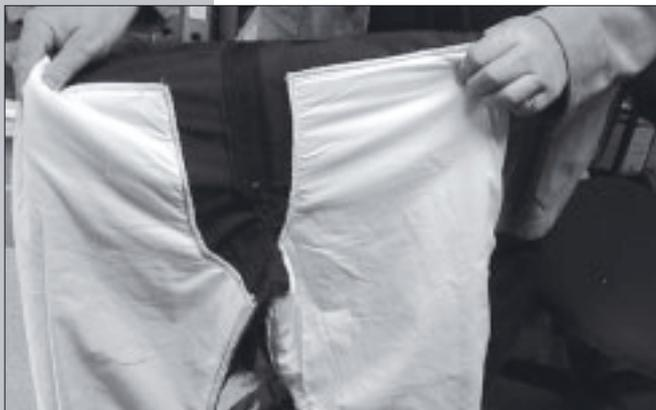
Abb. 4: Hose mit nicht ausreichendem Schnittschutz im Vorderbereich, erlaubt ist eine Lücke von 30 mm
