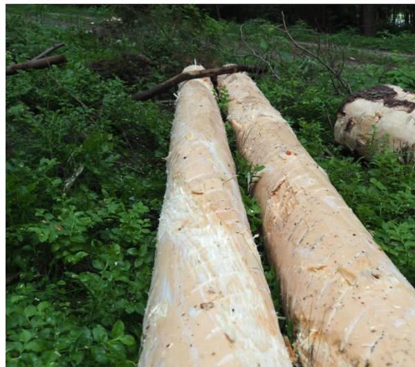
Abbildung 12: Vollständig vom Debarking Head entrindete Sägeabschnitte links sehr guter, rechts mittlerer Qualität (Hauck)
