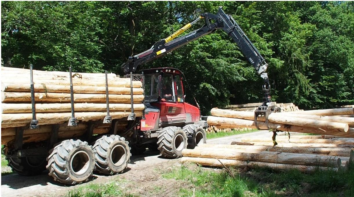
Abbildung 13: Komatsu 845 beim Poltern entrindeter Abschnitte (Hauck)
