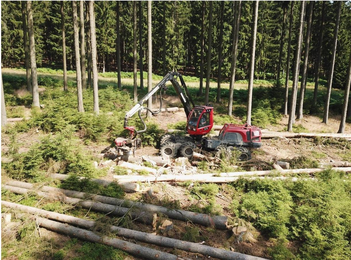
Abbildung 34: Einsatz von Debarking Heads in einem Käferloch (Lippert)
