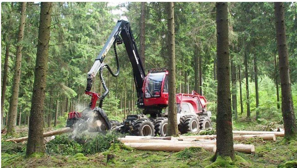
Abbildung 10: Komatsu 931 XC mit S-132 Aggregat im Einsatz (Hauck)
