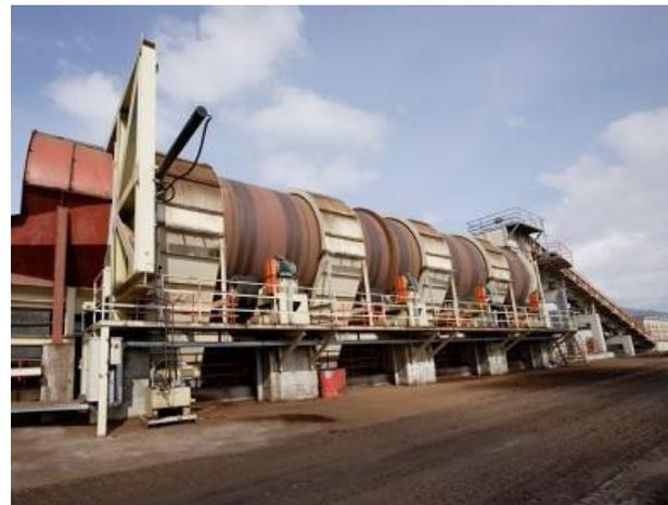
*Abbildung 22: links: Rotorenrinder, Model PRD der Firma Pallmann, rechts: Moderne Trommelentrindungsanlage; Typ PDD der Firma Pallmann (beide Pallmann Maschinenfabrik GmbH & Co.KG).*
