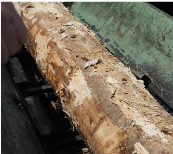
Abbildung 11: Sägeabschnitt nach Entrindung im Sägewerk (Hauck)
