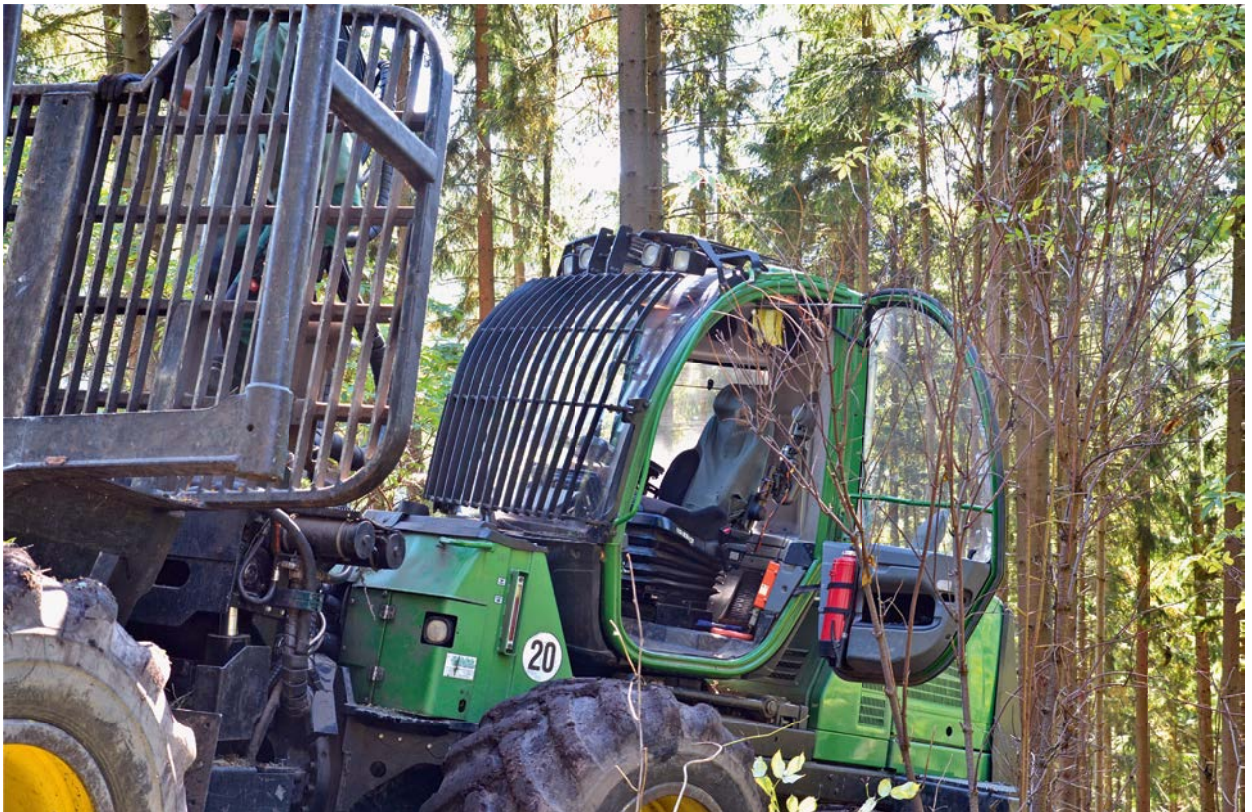
Abbildung 18: Schutzgitter an der Kabine eines Forwarders zum Schutz gegen Abschnitte, die bei der Fahrt im Hang aus dem Runnenkorb herauspringen können
