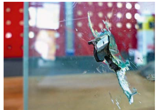
Abbildung 5: Sägekettenbruchstück in einer Kabinenschutzverglasung (Abbildung KR D)
