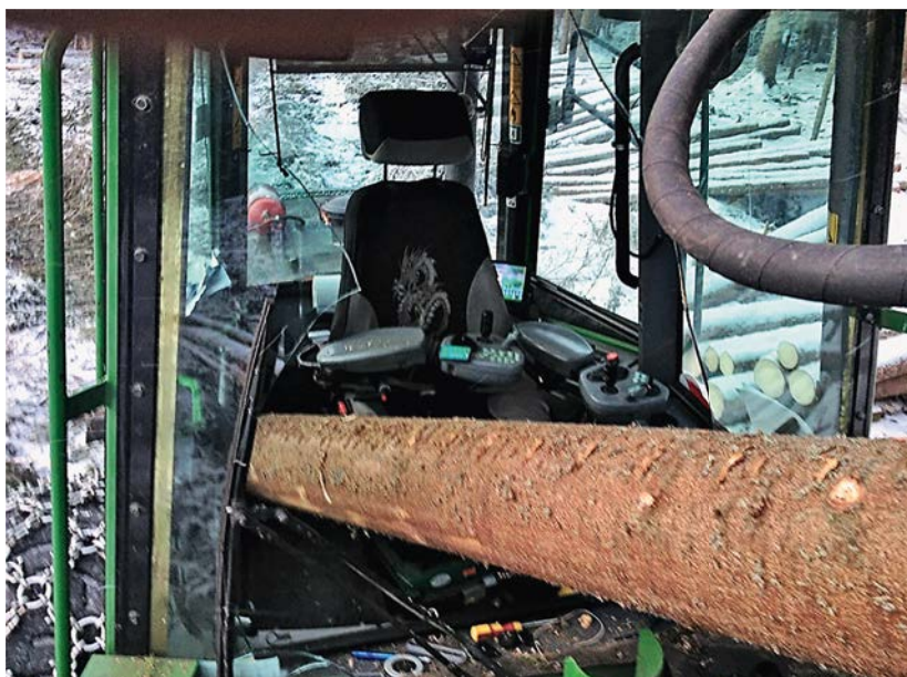
Abbildung 17: Bei der Ladearbeit durchschlagene Kabinenscheibe eines Forwarders (Foto: Lars-Olov Eriksson)
