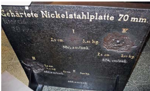
Abbildung 13: Beschussversuch von mit Nickel legiertem und gehärtetem Stahl (Deutsches Museum, München)
