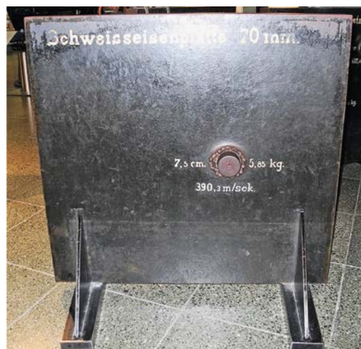
Abbildung 11: Beschussversuch von unlegiertem Schweißstahl (Deutsches Museum, München)
