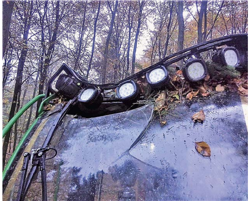
Abbildung 2: Harvester-Kabine nach dem Sturz eines Baumes auf die Maschine (Abbildung Henning Geske, Niedersächsische Landesforsten)
