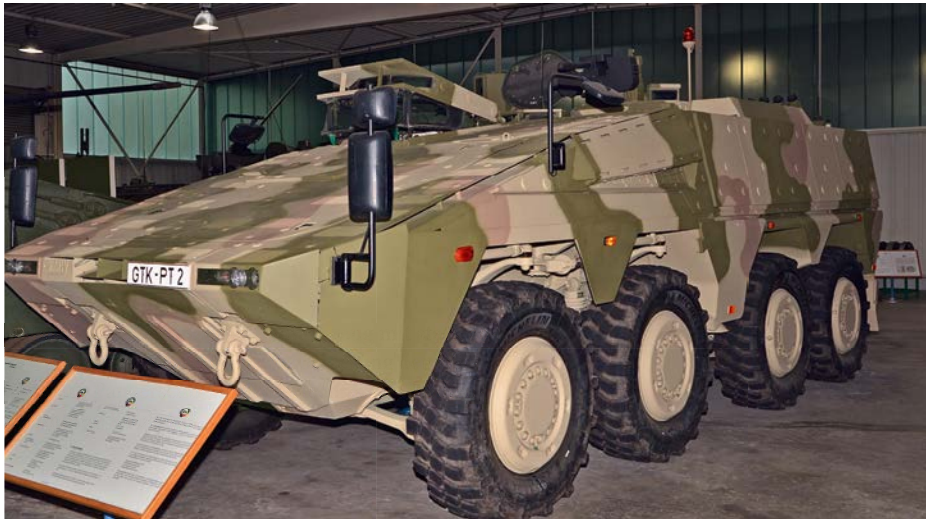
Abbildung 7: Gepanzertes Radfahrzeug mit stark abgeschrägter Frontpartie zur Verbesserung der Wirkung des Panzerschutzes (Wehrtechnische Studiensammlung Koblenz)
