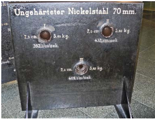
Abbildung 12: Beschussversuch von mit Nickel legiertem Stahl (Deutsches Museum, München)
