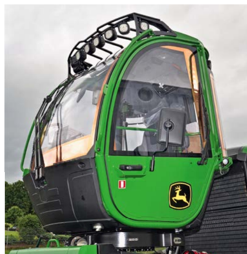
Abbildung 10: Forstmaschinenkabine Bauart John Deere mit geneigter Frontscheibe
