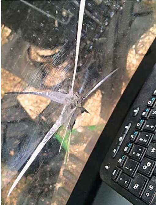
Abbildung 1: Kettenschusseinschlag in einer Harvester-Scheibe
