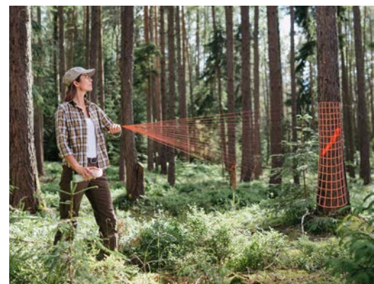
Abbildung 1: Dimetree – Mithilfe des Durchmessers wird das Holzvolumen der Einzelstämme in Echtzeit berechnet.
