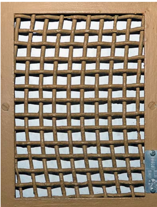
Abbildung 14: Maschendraht-Schutzgitter von der Seitenschürzenpanzerung eines deutschen Panzers des zweiten Weltkriegs (Wehrtechnische Studiensammlung Koblenz)
