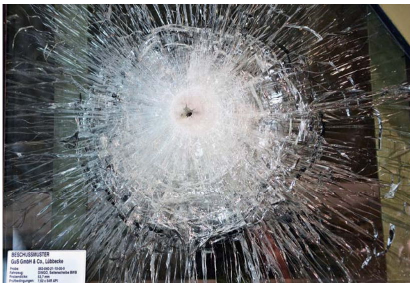
Abbildung 16: Beschussprüfmuster einer militärischen Schutzverglasung (Wehrtechnische Studiensammlung Koblenz)
