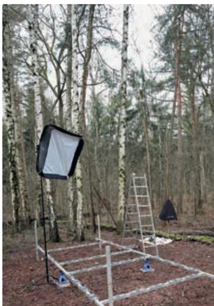
Abbildung 3: Messrahmen für die photogrammetrische Datenaufnahme
