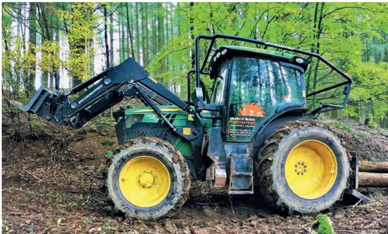
Abbildung 3: Forstraktor Typ „John Deere 6120 R“ mit Forstausrüstung Bauart Kotschenreuther
