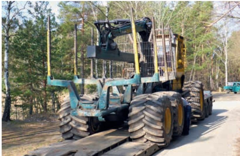
Abbildung 1: Superbreitreifen auf dem HSM 208 F 6WD
