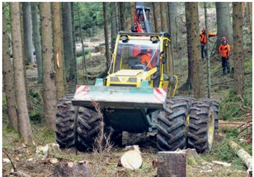
Abbildung 2: Twin Tyre bei der Langholzurückung
