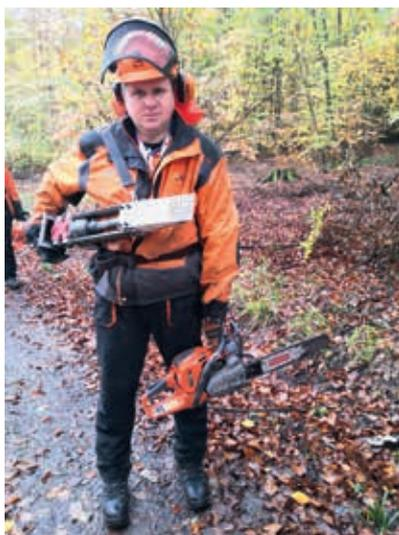
Abbildung 3: Ein Mitarbeiter der NSW Forst mit funkferngesteuertem Fällkeil
