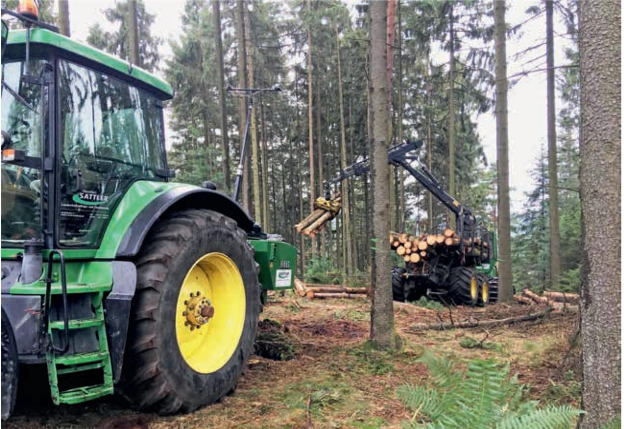
Abbildung 1: Bodenschonung durch Traktionswindeneinsatz im Hangübergangsgelände
