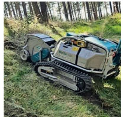
Abbildung 1: Pflanzelt Moritz FR 50 mit Fräs-Saatmaschine
