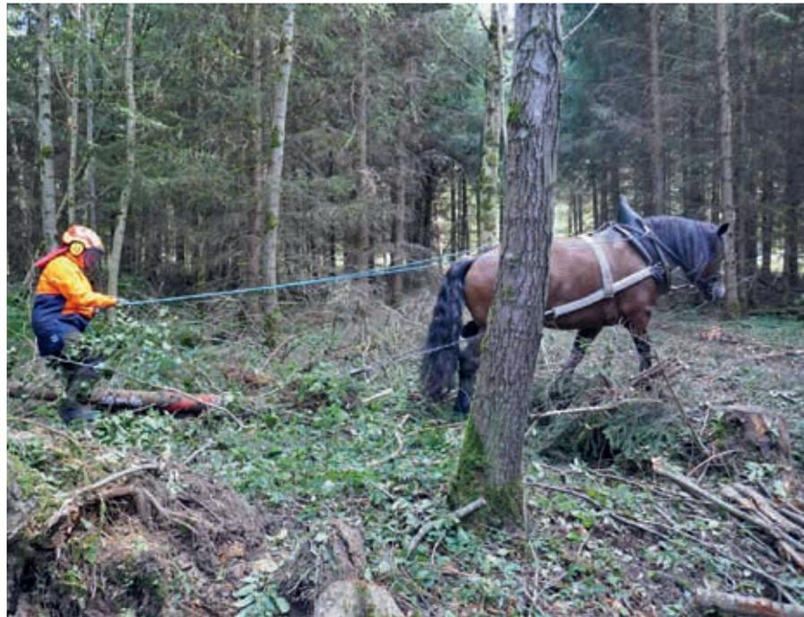
Abbildung 2: Vorrücken von Vollbäumen zur Rückegasse
