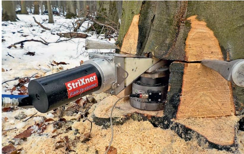
Abb. 7: Montierter Messaufbau zur Ermittlung der Hubkraft
