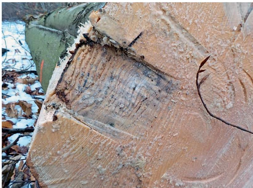
Abb. 9: Grenzbereich der Fällhilfen: Verformung des Holzes durch eine hohe Hubkraft
