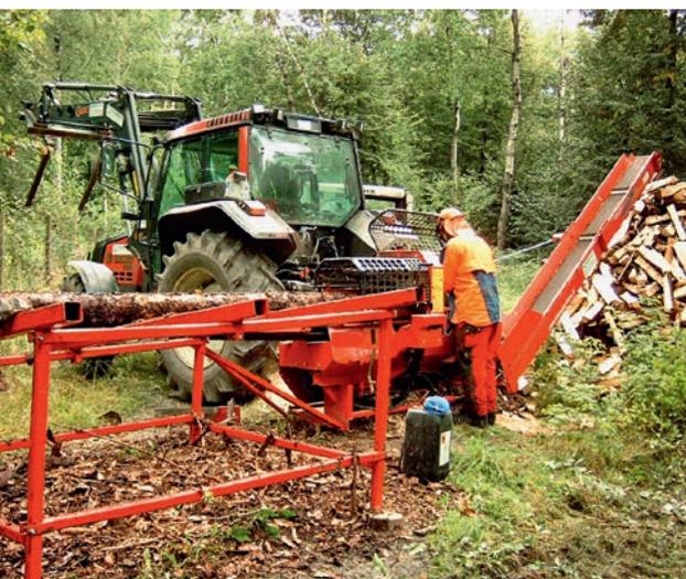
Abbildung 2: Sicher und schnell: Wenn große Mengen Brennholz aufgearbeitet werden müssen, sind Säge-Spalt-Automaten die erste Wahl. (Fotos: SVLFG)
