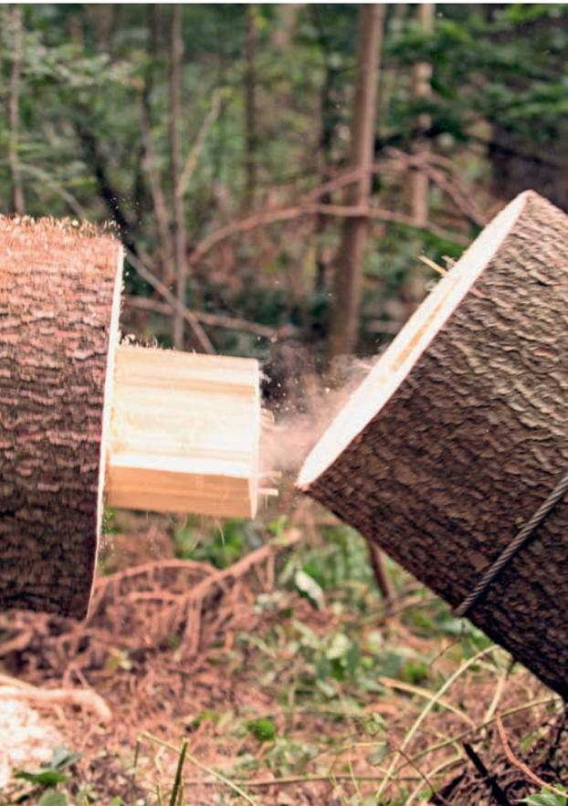
Abbildung 3: Zapfenschnitt im Moment des Abreißens
