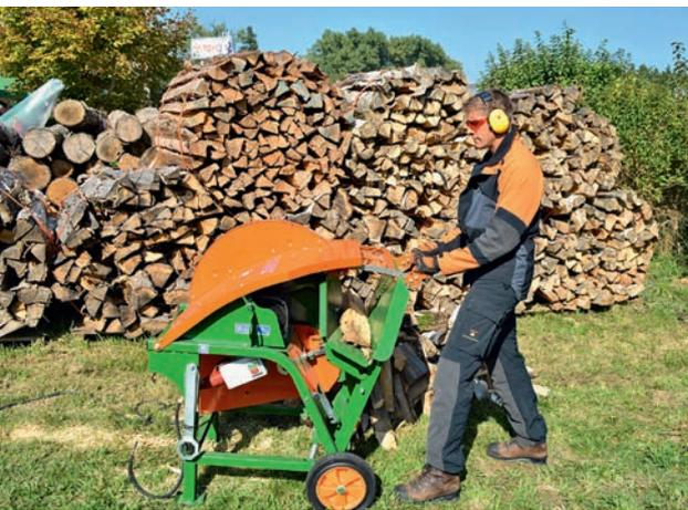
Abbildung 1: Hier schützt beim Scheite-Sägen ein Deckel auf der Wipp-Kreis-säge den Bediener vor Verletzungen.
