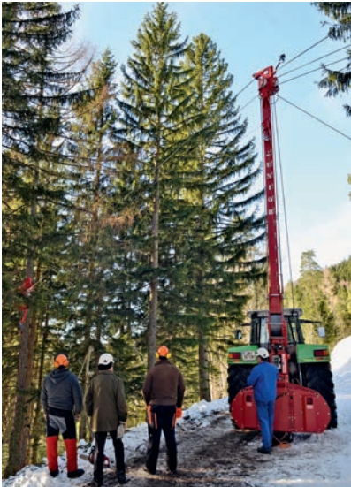
Abbildung 7: Seilkrananlage „Tröstl TST Junior mit Laufwagen TST 2500/I“ (Foto Weise)
