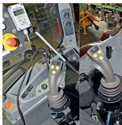
Abbildung 2: Joysticks zur Bedienung des Hackers Heizomat HM 8-400 KFL
