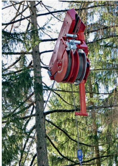
Abbildung 8: Laufwagen „TST 2500/I“ mit 3-fächriger Trommel und separatem Arbeitsseil; Abwickelspule mit Rückhohlseil links, Aufwickelspule mit Zugseil Mitte, Arbeitsspule rechts (Foto Weise)
