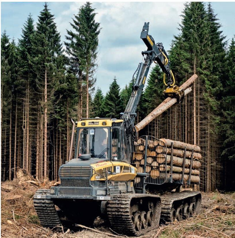
Abbildung 1: Als Basisfahrzeug wird einerseits ein Standard-Forwarder Ponsse Buffalo mit 14 t Nutzlast genutzt, dessen acht Reifen durch pendelnd gelagerte, gummiummantelte Raupenfahrwerke des Südtiroler Pistenfahrzeugeherstellers Prinoth ersetzt wurden. Andererseits wurde ein 2D-Lasersensor entwickelt, der während der Befahrung die Gleisbildung des Bodens vermisst.
