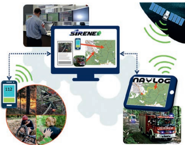
Abbildung 2: Durch das Smartphone bestimmt die Rettungs-App die Position des Unfallortes und überträgt eine Geokoordinate an die Rettungssuite in der Einsatzleitstelle. Von dort werden Informationen an den Rettungslotsen im Einsatzfahrzeug übermittelt, welcher eine ideale Route zur Anfahrt errechnet und bereitstellt. Ein permanenter Austausch von Standortdaten unterstützt die Steuerung des gesamten Rettungsprozesses.
