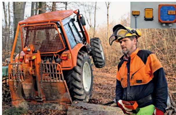
Abbildung 13: Anti-Kipp-System für Funkforstseilwinden“ Bias-tec AKS 2515“ (Foto Nemestothy)
