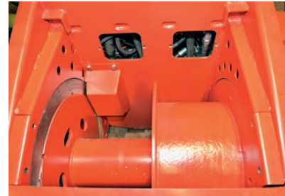
Abbildung 9: Große, niedrig angeordnete Zugseiltrommel mit separatem Arbeitsfach der Seilkrananlage „Tröstl TST Junior“ (Foto Weise)
