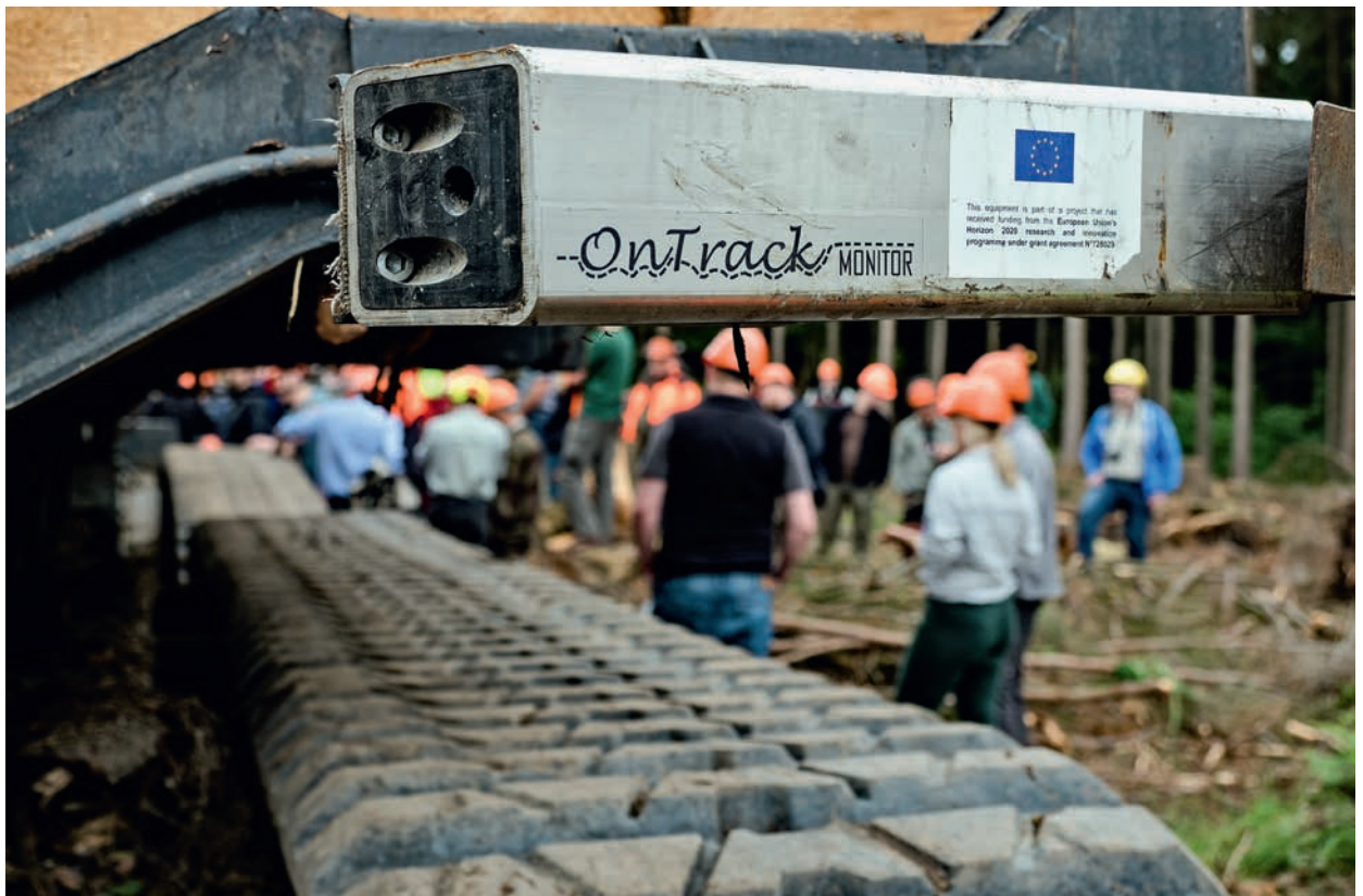
Abbildung 2: Einer der vier 2D-Laserscanner – hinten am Runnenwagen
