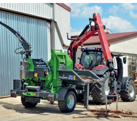
Abbildung 1: Hacker Heizomat HM 8-400 KFL in Arbeitsstellung
