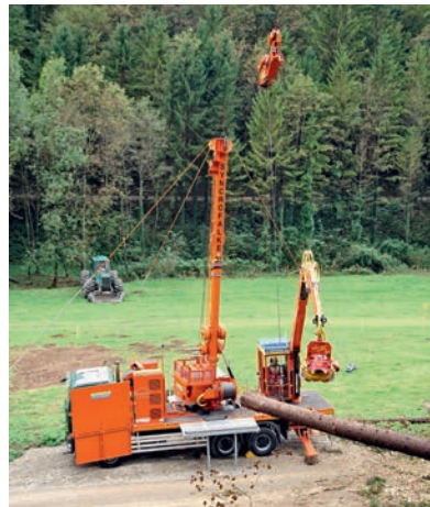
Abbildung 12: Seilkran „MM-Syncrofalke-U 3-t Telemast mit Laufwagen MM-Sherpa U-3-t“ (Foto Nemestothy)
