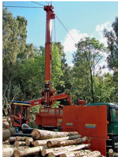
Abbildung 13: Seilkran „MM-Syncrofalke-U 4-t mit Laufwagen MM-Sherpa-U 4t XL“ (Foto Nemestothy)
