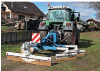
Abbildung 10: Wegpflegegerät „Wullems SWO 1“ (Foto Debnar)
