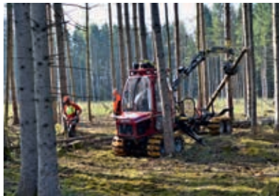
Abbildung 9: Mini Forwarder „Alstor 833“ bei der Kurzholzernte mit Zwei-Mann-Rotte Motorsägenführer (Foto Weise)
