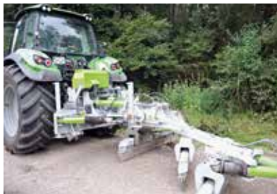
Abbildung 11: Wegpflegegerät „Metallvielfalten“ (Foto Dietz)
