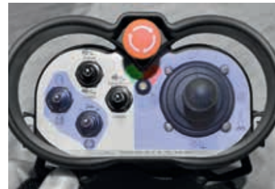
Abbildung 14: Fahrfunksystem Bauart „Wahlers“ (Foto Weise)
