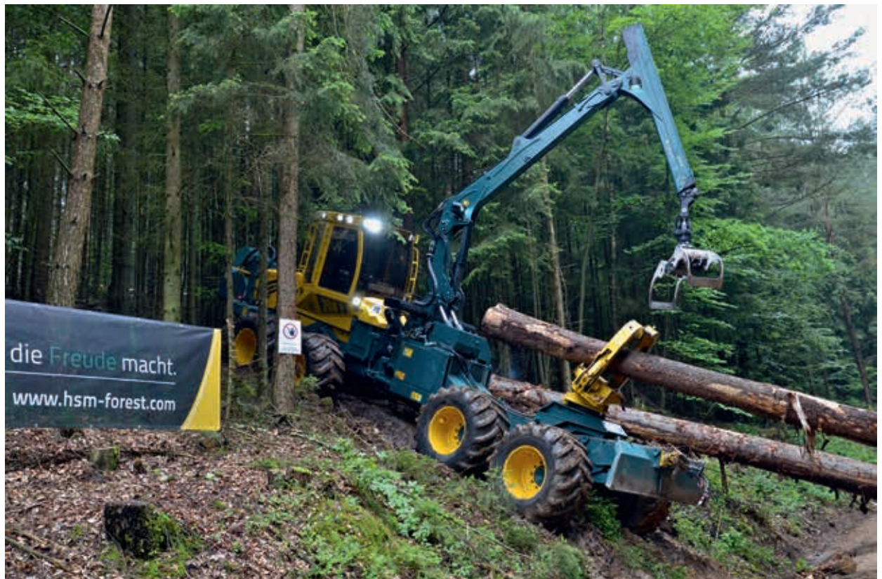
Abbildung 13: Traktionshilfswindensystem HSM HSW 7 zur Langholzrückung mit Klemmbankforwarder
