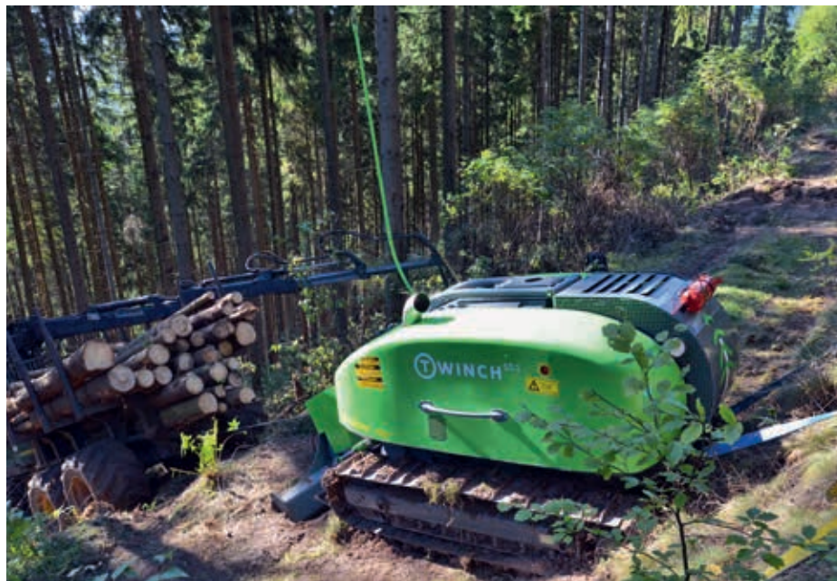
Abbildung 14: Autonome Traktionshilfswinde Bauart ecoforst T-Winch
