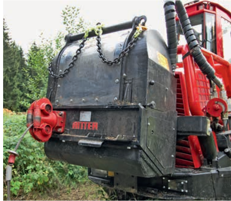
Abbildung 12: Abnehmbares externes Traktionshilfswindensystem für Harvester Bauart Komatsu SPW
