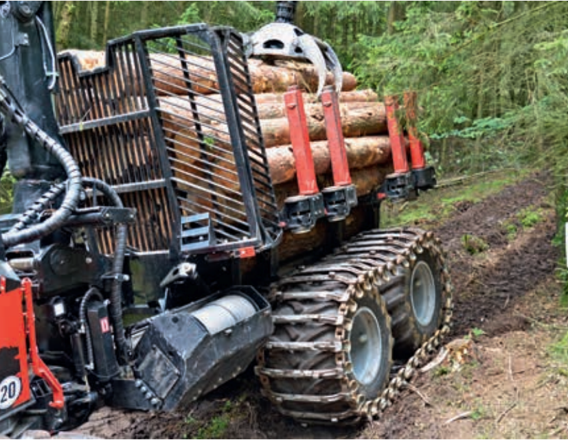
Abbildung 11: In Forwarder integrierte Traktionshilfswinde Bauart Komatsu SPW
