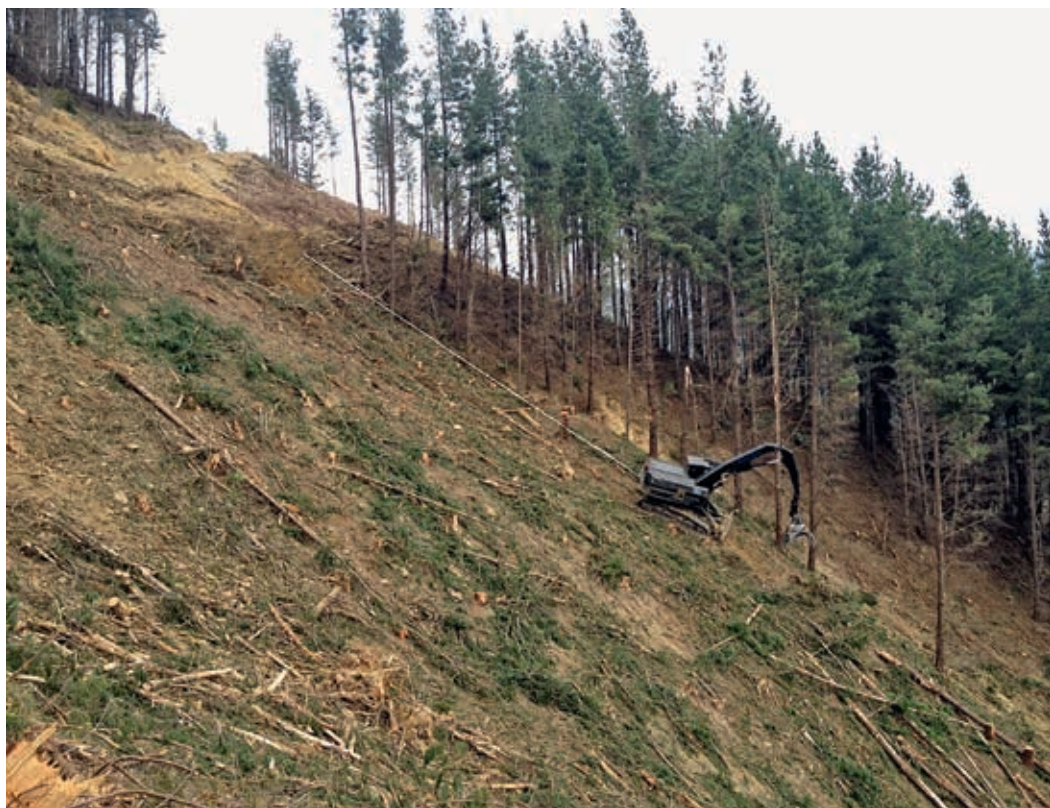
Abbildung 10: Steilhangharvester Bauart ClimbMAX; Seilverlauf hervorgehoben; Wiedergabe des Fotos mit freundliche Erlaubnis von ClimbMAX
