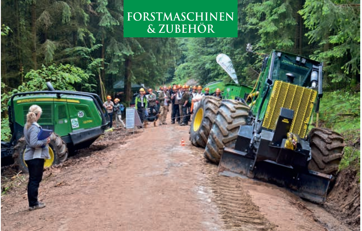
Abbildung 16: Autonomes Traktionshilfswindensystem Bauart Haas
