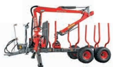
Abb. 34: Rückeanhänger Krpan GP 10 D (Werkbild Krpan)
