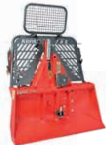
Abb. 18: Anbaurückwinde Krpan 7,5 E (Werkbild Krpan)
