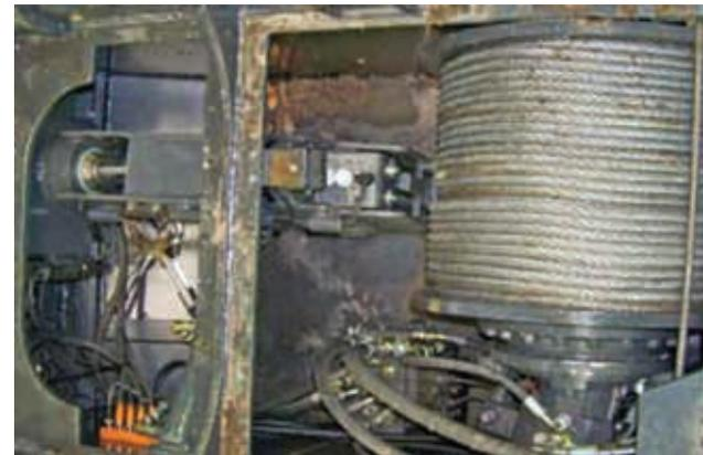
Abb. 2: Traktionshilfswinde Forwarder (Foto: Weise)
