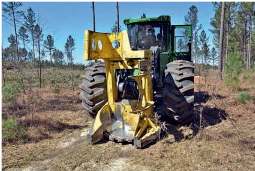
Abb. 10: Amerikanischer Fäller-Sammler mit Kreissäge und Sammleraggregat für Vollbaum-bunde Bauart John Deere 643 L (Foto Weise)
