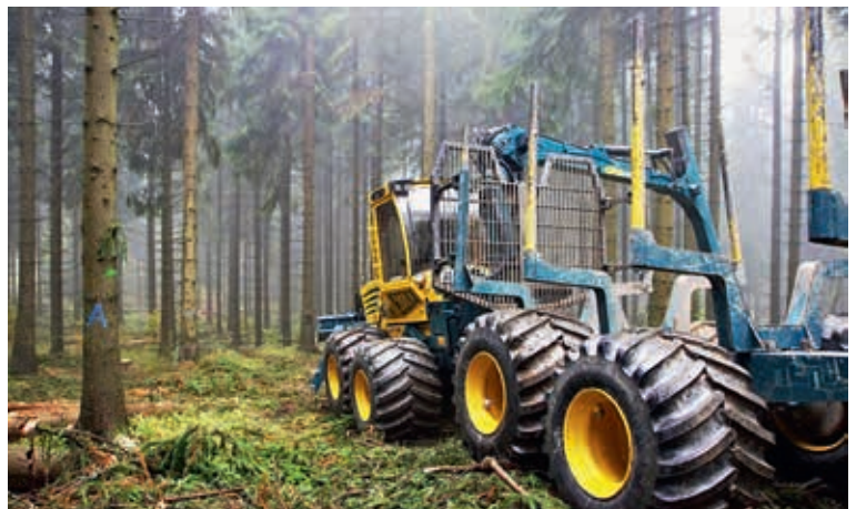
Forwarder HSM BigFoot mit 94 cm Superbreitreifen (SBS, Heubaum, 2015)
