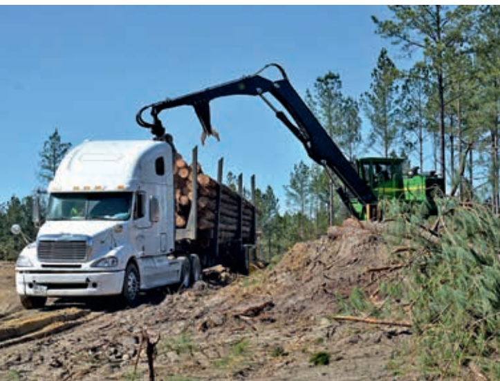
Abb. 16: Lkw-Beladung mit dem Holz-Lade- und Sortierkran (Foto Weise)
