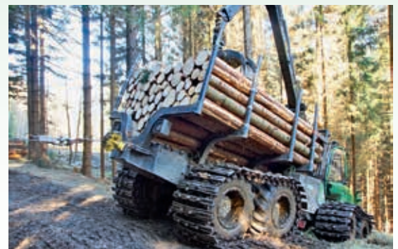
Forwarder mit kombinierten Bändern Terra-X Combi und Unterstützung durch Traktionshilfswinde (SBS, Heubaum, 2015)
