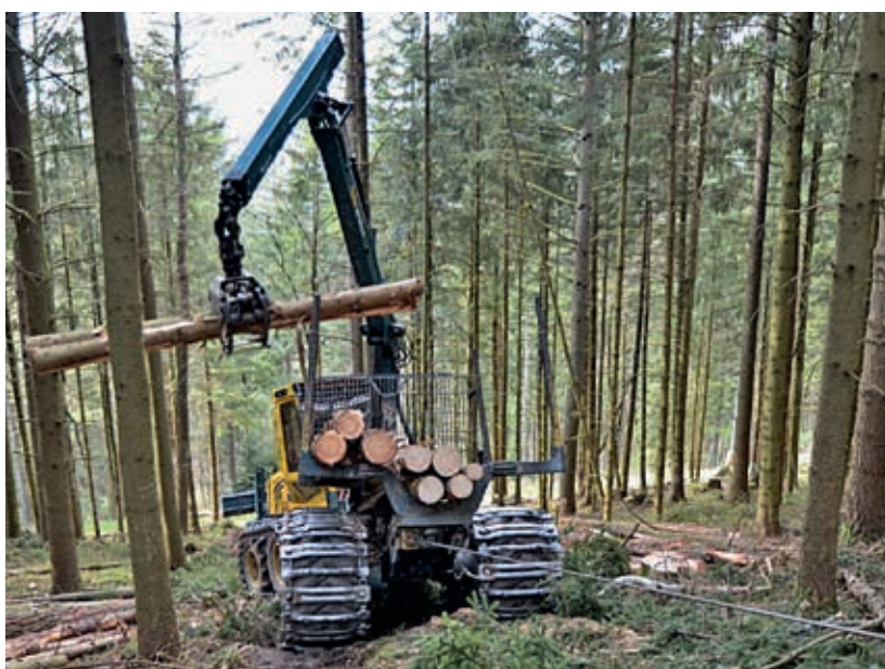
Abb. 8: Forwader mit Traktionsunterstützungswinde (Foto Weise)
