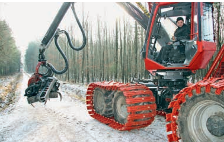
Harvester mit überbreiten Moorbändern Terra-X TXTL 150 sowie Einzelradbändern (SBS, Leonhardt, 2013)
