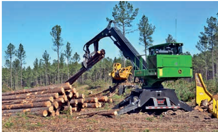
Abb. 15: Poltern der aufgearbeiteten Schäfte mit dem Holz-Lade- und Sortierkran (Foto Weise)
