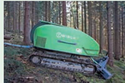
externe Traktionshilfswinde t-Winch (SBS, Heubaum, 2015)
