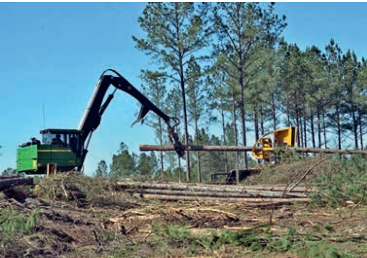
Abb. 14: Aufarbeiten eines vom Zangenskidder gelieferten Bundes von Ganzbäumen mit dem Holz-Lade- und Sortierkran und Entastungsvorrichtung mit Kappsäge (Foto Weise)
