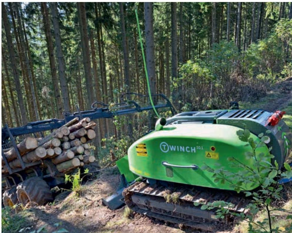
Traktionshilfswindensystem „T-winch 10.1“ Bauart ecoforst
