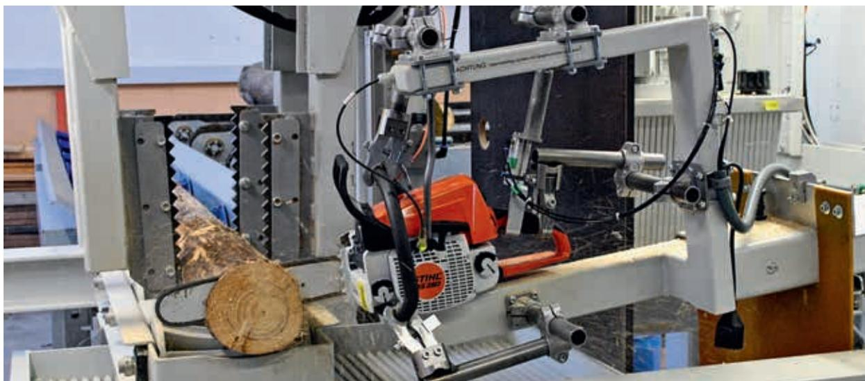
Der neue Dauerlaufprüfstand für Motorsägen in Aktion
