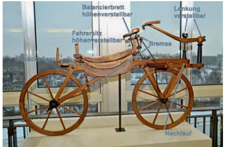
Abbildung 2: Aufbau der Drais'schen Laufmaschine
