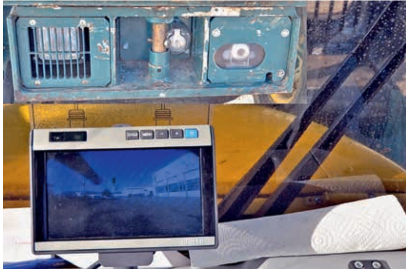
Abbildung 1: Rückfahrkamera im Heckabschlussträger eines Forwarders und Monitor in der Kabine
