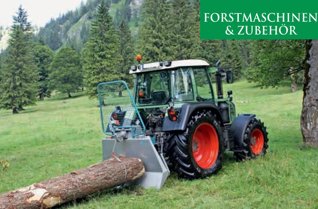
Rückeseilwinde Typ „PM 9172 S-line“ Bauart Pfanzelt (Werkbild Pfanzelt)
