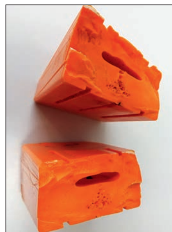
Nicht FPA – geprüfter Kunststoffkeil, geborsten aufgrund von Luftfeinschlüssen (Foto KWF)
