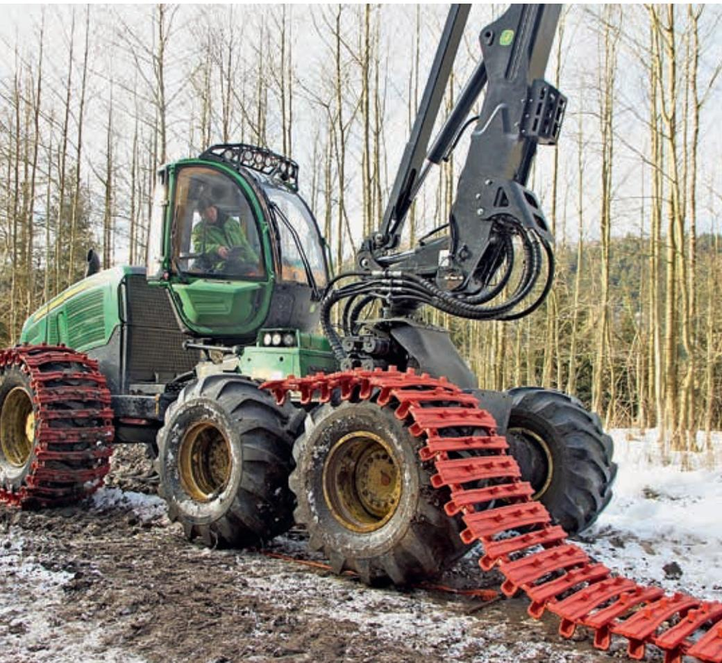
Abbildung 1: Harvester mit Einzelrad- und Bogieband während der Montage
