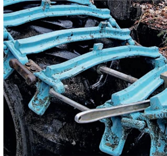
Abbildung 3: Montagewerkzeug von Bogiebändern, Olofsfors
