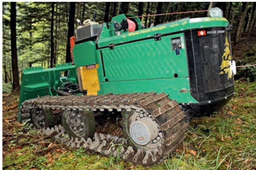
Abbildung 2: Vorrücken von Vollbäumen mit Vorliefer-Raupe (Quelle: FMB Schrofel)
