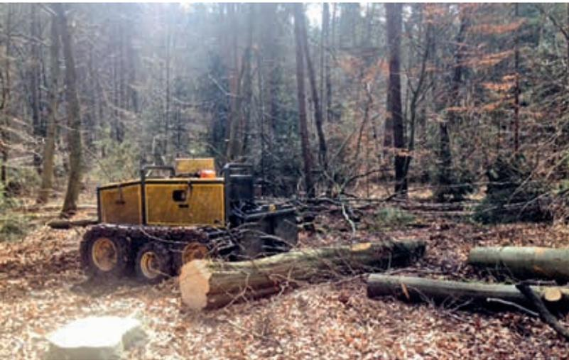
Abbildung 5: Vorrücken von ausgeformten Kurzholz-Sortimenten
