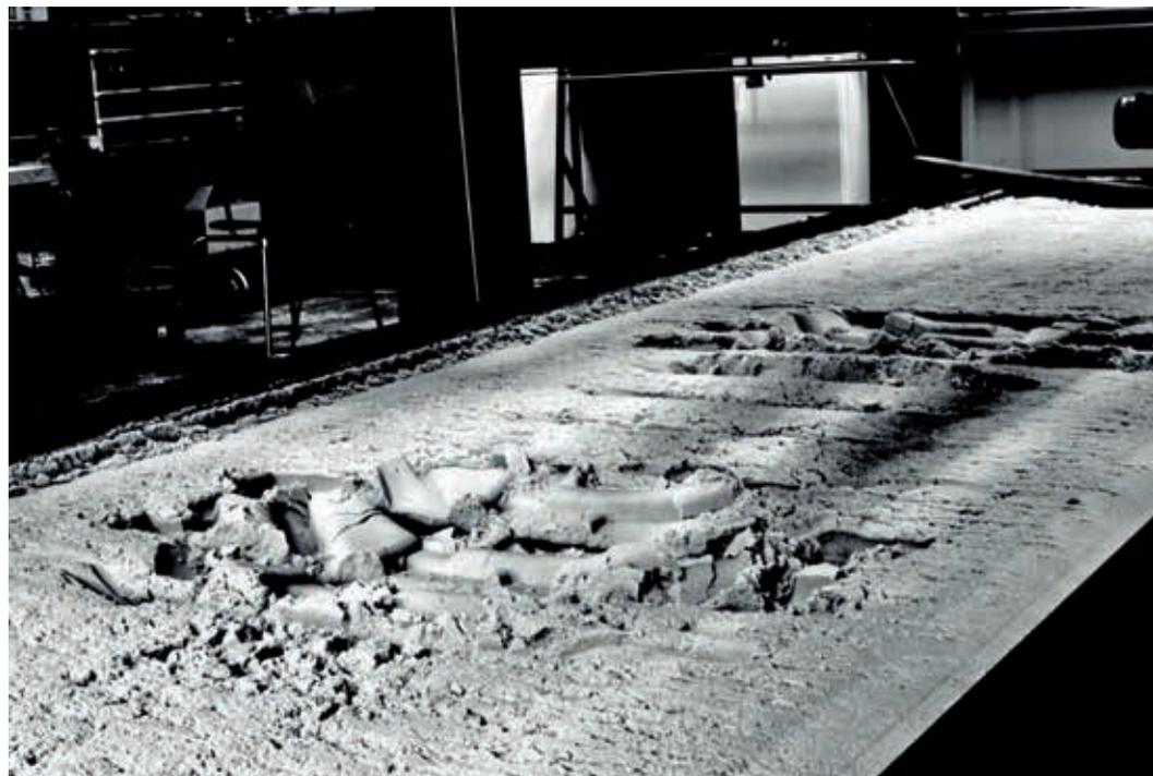
Abbildung 3: Abdruck eines korrekt gespannten Bogiebandes im Sand des ifa-Prüfstands; Bandtyp TRACK (OLOFSFORS) über NOKIAN Forest King F 710/40 – 22.5, Fülldruck 4,5 bar, vorherige Achslast ca. 28 t
