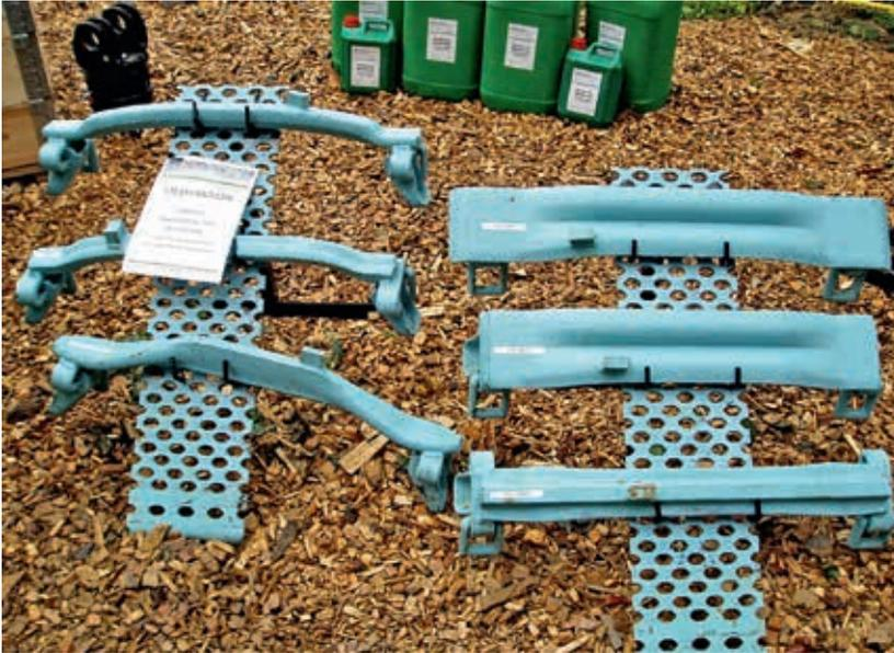
Abbildung 2: Unterschiedliche Plattentypen, Olofsfors
