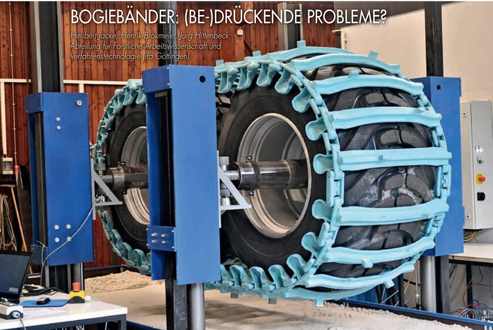
Abbildung 1: Der neue Prüfstand zur Bemessung des Kontaktflächendrucks (auch) unter Bogieachsen
