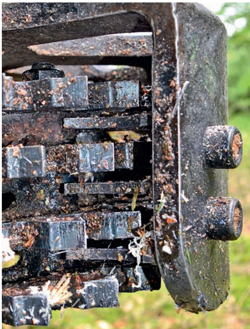
Abbildung 5: Reinigungskralen zur Entfernung von Rindenmaterial aus den Zahnringzwischenräumen
