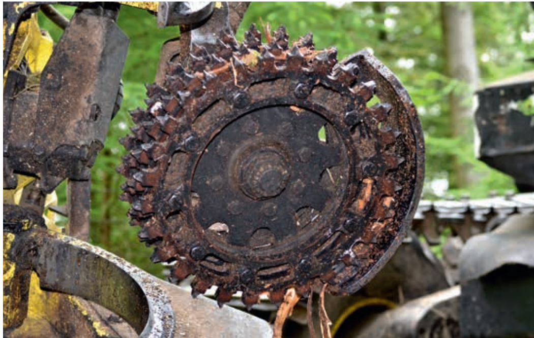
Abbildung 1: TP-Rollers montiert im Aggregat
