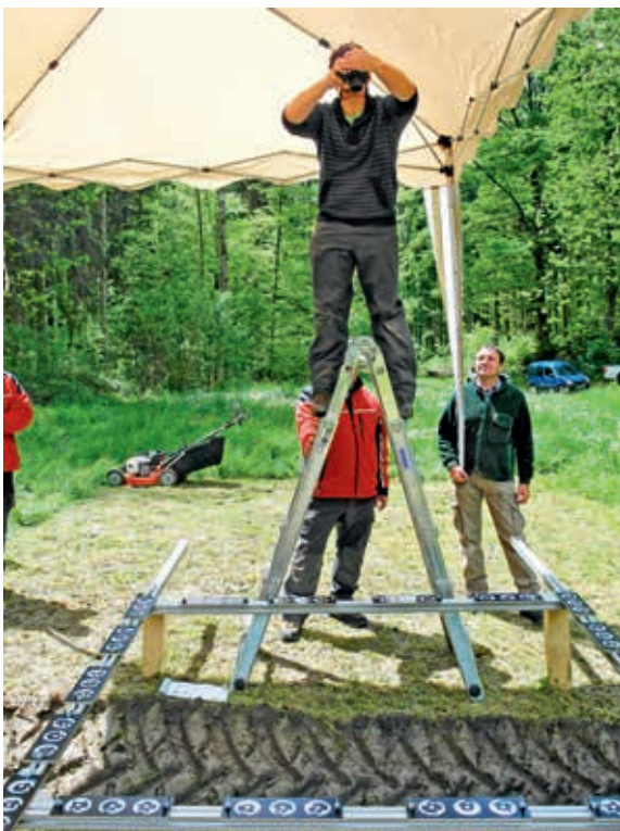
Abbildung 1: Fotogrammetrische Fahrspuraufnahme mit Targethilfsrahmen und Sonnenschutz
