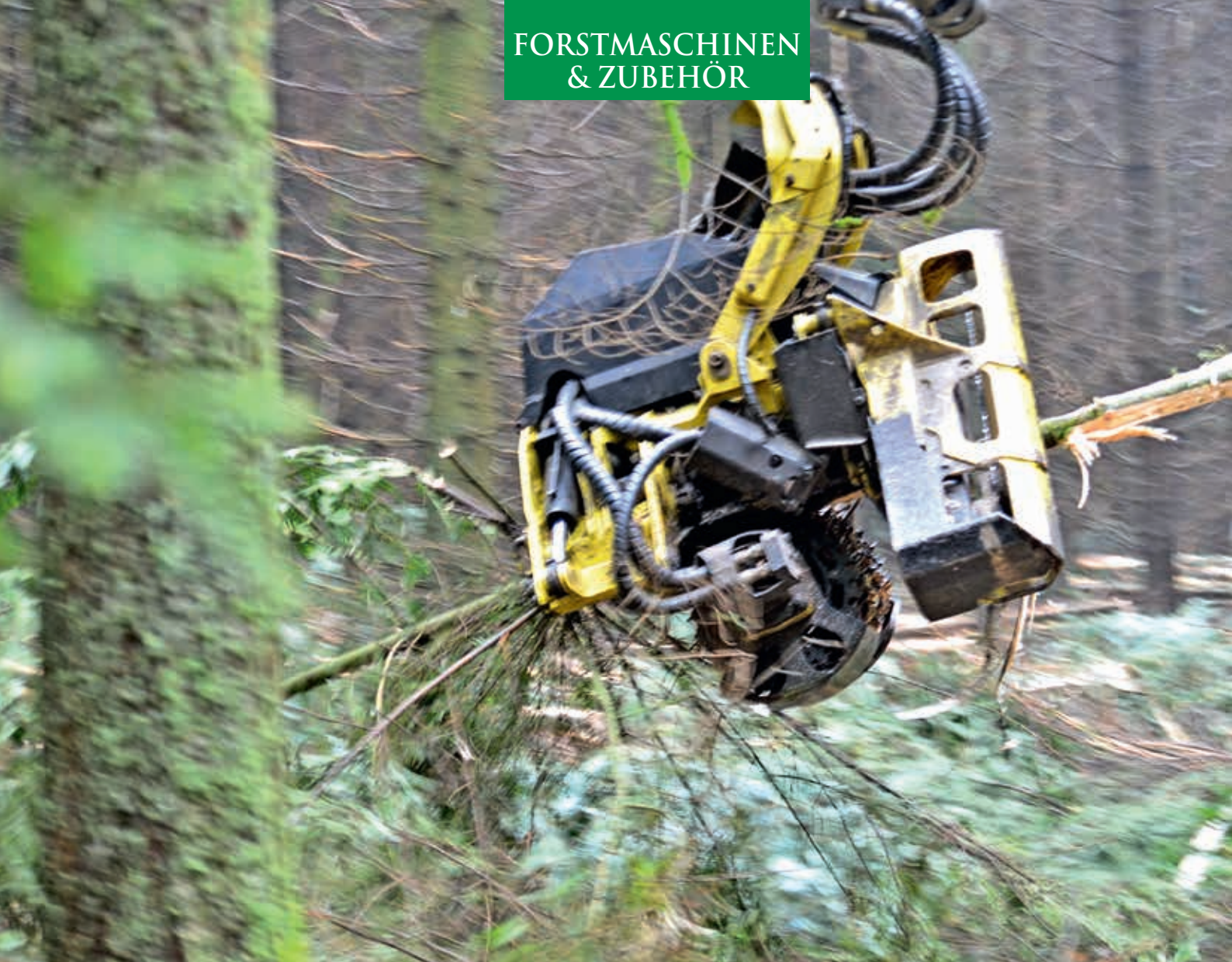
Abbildung 4: TP-Rollers im Einsatz am Harvester des Forstlichen Bildungszentrums Arnsberg. Auch relativ dünne Stammteile können noch aufgearbeitet werden, ehe gezopft werden muss.
