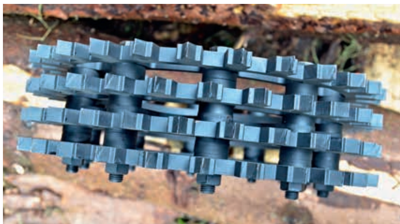
Abbildung 3: Aufbau der TP-Roller, die aus Zahnringen und Abstandhaltern bestehen, die durch Schraubverbindungen zusammengehalten werden.
