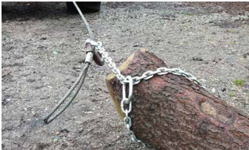
Abbildung 7: Befestigung einer Umlenkrolle am Ankerbaum
