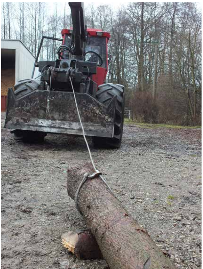
Abbildung 1: Forstspezialschlepper mit Aufbauseilwinde
