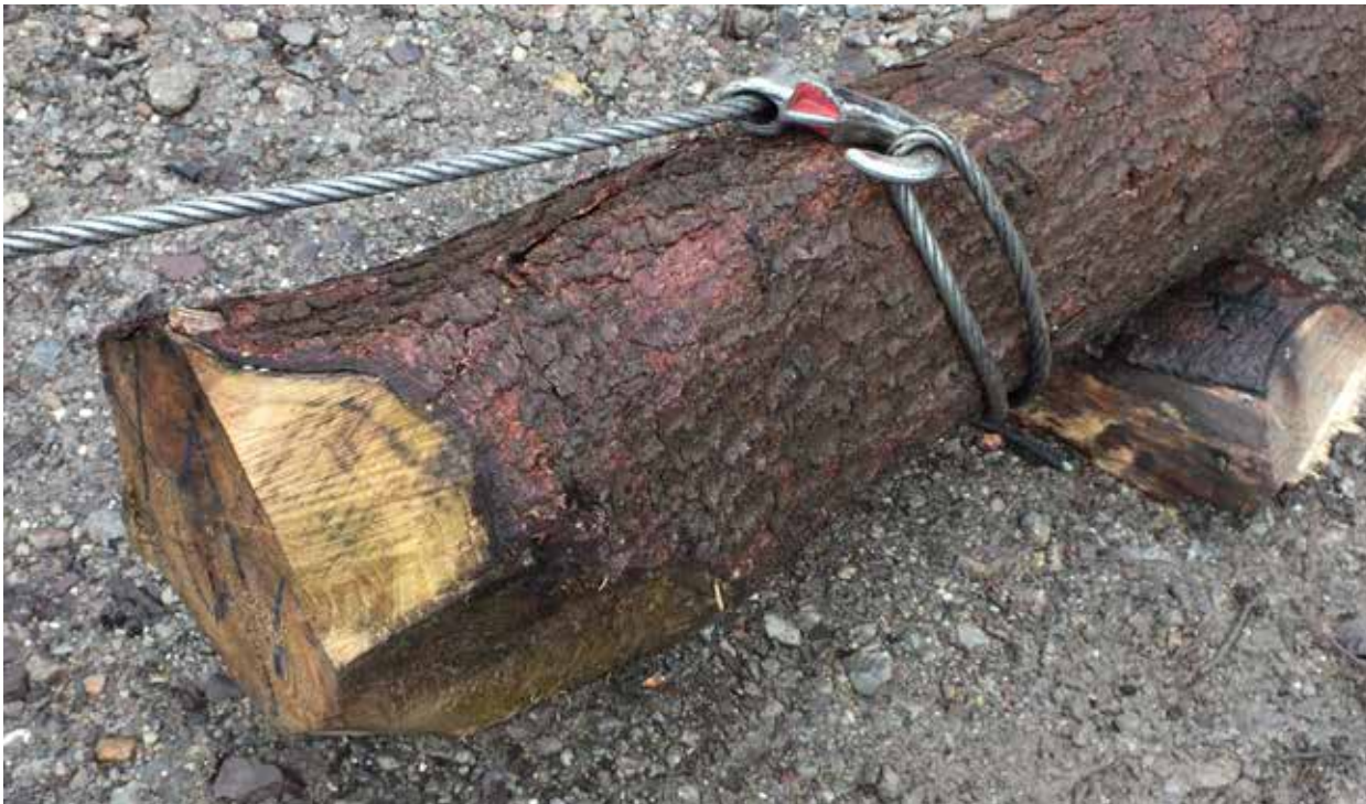
Abbildung 6: Direktes Anschlagen mit dem Windenseil
