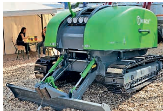
Abbildung 24: Mobile Traktionshilfswinde von Ecoforest (Foto Weise)
