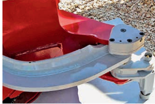
Abbildung 22: Vierpunktvermessung von LogMax (Foto Burk)
