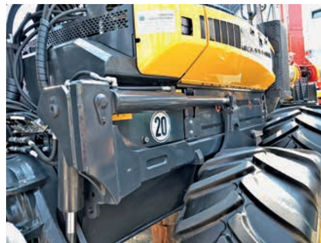
Abbildung 5: Bogielifeinrichtung für Ponsse Forwarder, Frontanordnung (Foto Weise)
