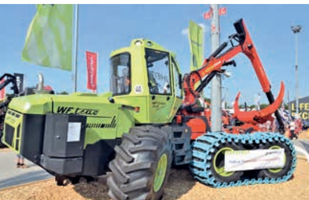
Abbildung 8: Bodendruckoptimierte Version des WF Trac 6x6 (Foto Weise)
