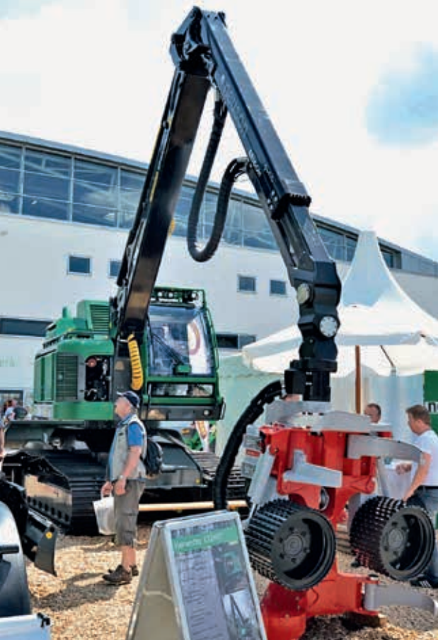
Abbildung 6: Kran Bauart Epsilon Palfinger an einem Neuson Raupenharvester mit innenliegender geschützter Schlauchführung und Endlosrotator mit Drehdurchführung der Hydraulikleitungen (Foto Weise)
