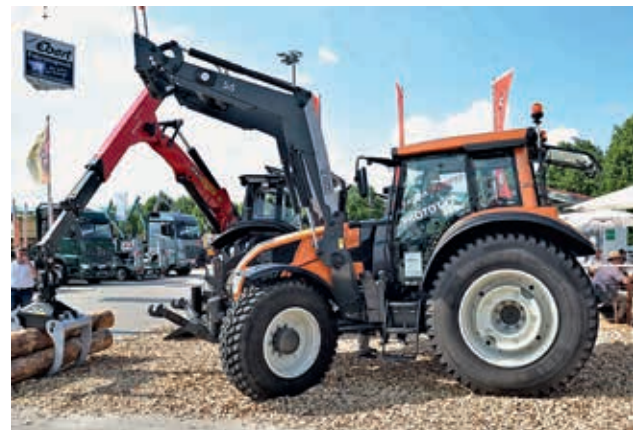
Abbildung 13: Valtra Traktor mit Knick- und Achsschenkelenkung (Foto Weise)
