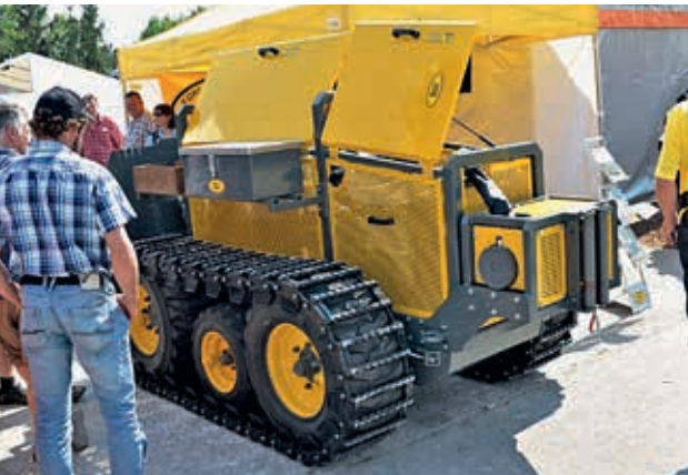
Abbildung 16: Vorlieferraupe Bauart Alther (Foto Weise)
