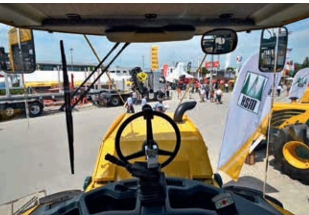
Abbildung 7: Sichtfeldaufnahme in Fahrtrichtung aus der sichtfeldoptimierten Skidderkabine von HSM (Foto Weise)
