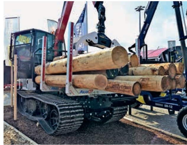
Abbildung 12: Raupenfahrzeug von Prinoth mit Gummibandlaufwerk der Technik von Pistenraupen für schwierige Bodenverhältnisse (Foto Weise)
