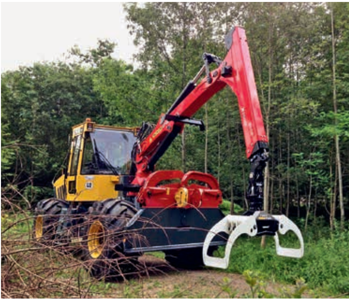
Abbildung 3: Skidder Welte W 230 mit Euro IV-Motor und in Arbeitsrichtung sichtoptimierter Kabine (Werkbild Welte)
