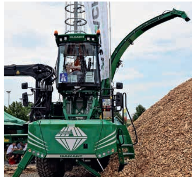
Abbildung 4: Mit dem neuen Albach Diamant wurde erstmals ein geländegängiger, selbstfahrender Hacker präsentiert.
