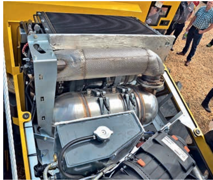
Abbildung 4: Partikelfilter und SCR-Katalysatoreinrichtung für den Euro IV Motor bei Welte (Foto Weise)
