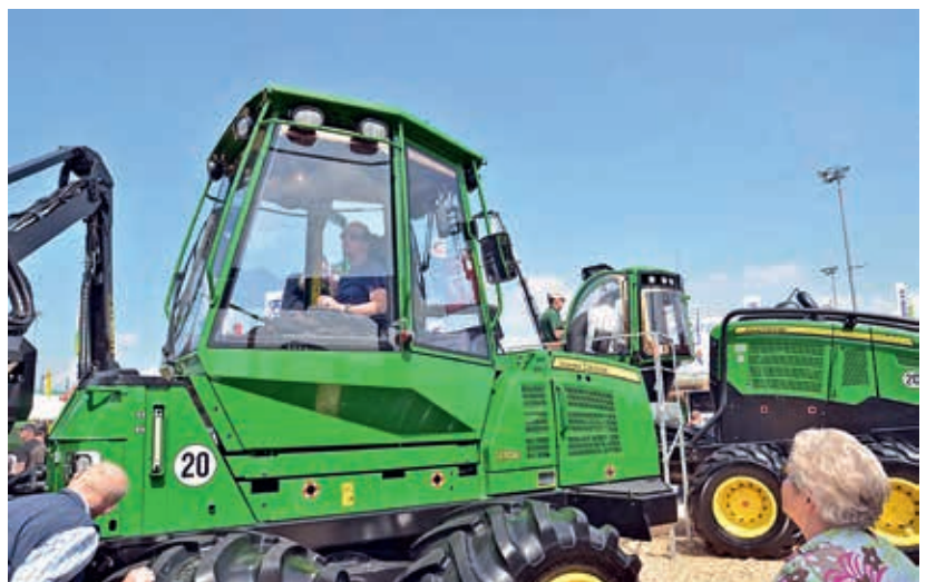
Abbildung 2: Neu entwickelte feste Kabine für John Deere Forwarder (Foto Weise)
