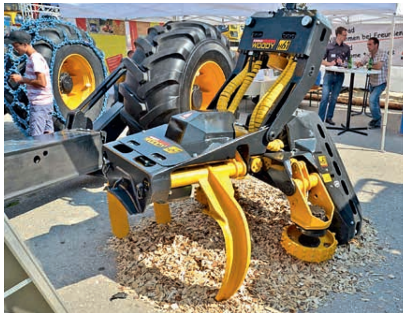
Abbildung 10: Aggregat Woody 61 mit 4-Walzenantrieb von Konrad Forsttechnik (Foto Weise)
