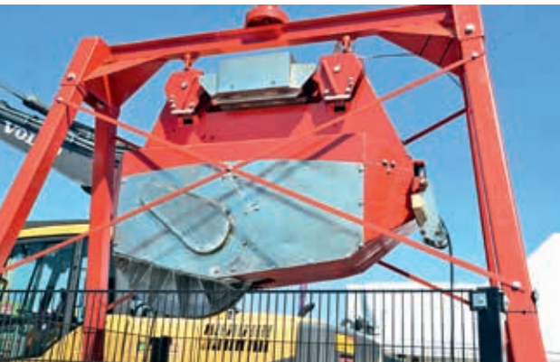
Abbildung 17: Prototyp des „Elektroausspuler“ Laufwagens von Koller mit starkem elektrischen Ausspulwerk ohne eigene Energieversorgung (Foto Weise)
