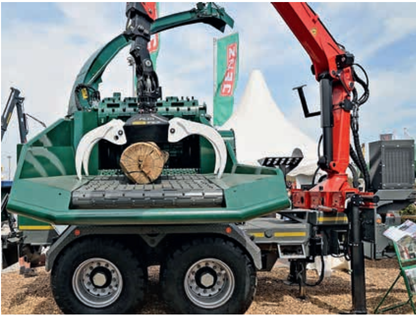
Abbildung 2: Jenz HEM 593 mit verbreitertem Einzug und geänderter Luffilteranbringung
